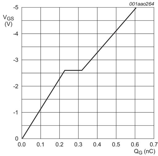
$I_D = -200 \text{ mA}$ ;  $V_{DS} = -15 \text{ V}$ ;  $T_{amb} = 25 \text{ }^\circ\text{C}$
