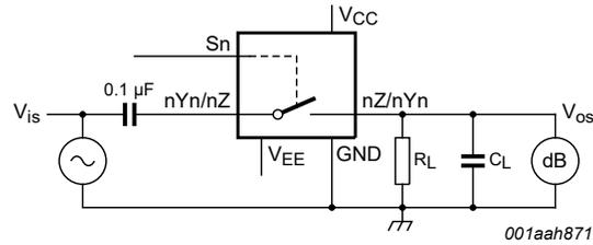
$V_{CC} = 4.5\text{ V}$ ;  $GND = 0\text{ V}$ ;  $V_{EE} = -4.5\text{ V}$ ;  $R_L = 600\ \Omega$ ;  $R_S = 1\text{ k}\Omega$ .
