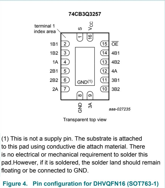
Figure 4. Pin configuration for DHVQFN16 (SOT763-1)
