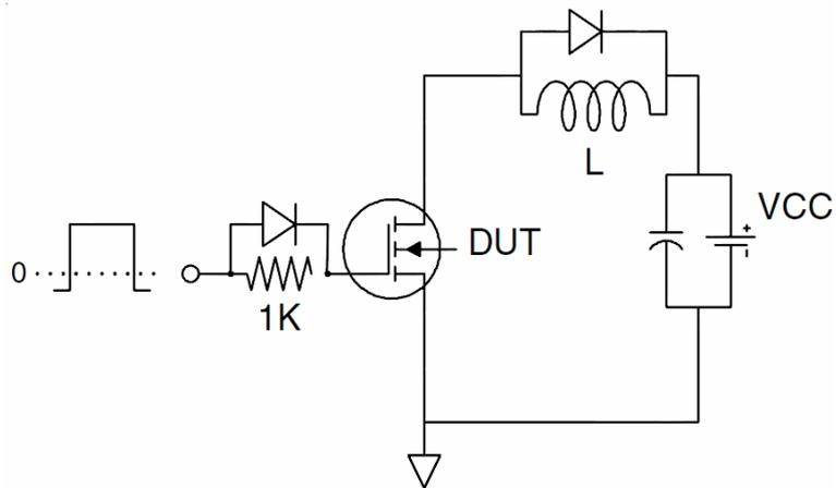
**3) Switch Time Test Circuit**
