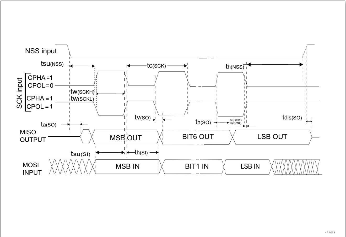
图 20. SPI 时序图 从模式和 CPHA = 1<sup>(1)</sup>
