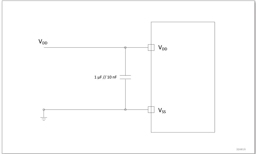
图 23. 供电电源和参考电源去藕线路
