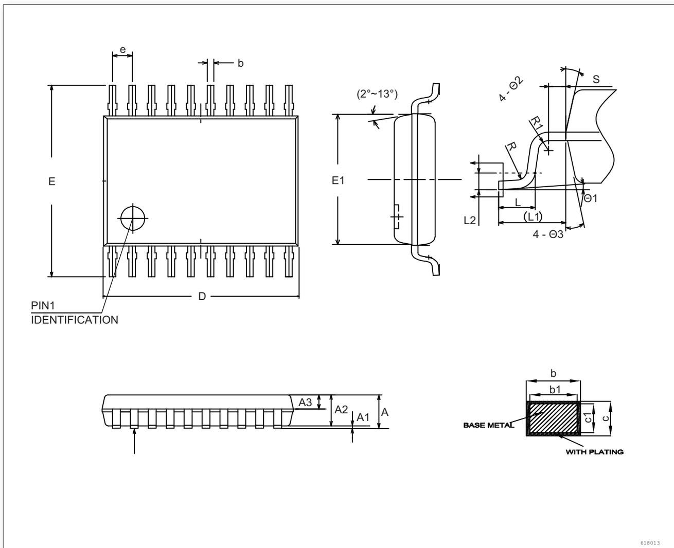
图 30. TSSOP20, 20 脚低剖面长方形扁平封装图
