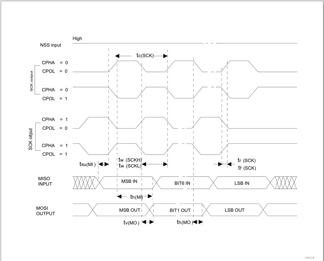
图 21. SPI 时序图-主模式<sup>(1)</sup>
