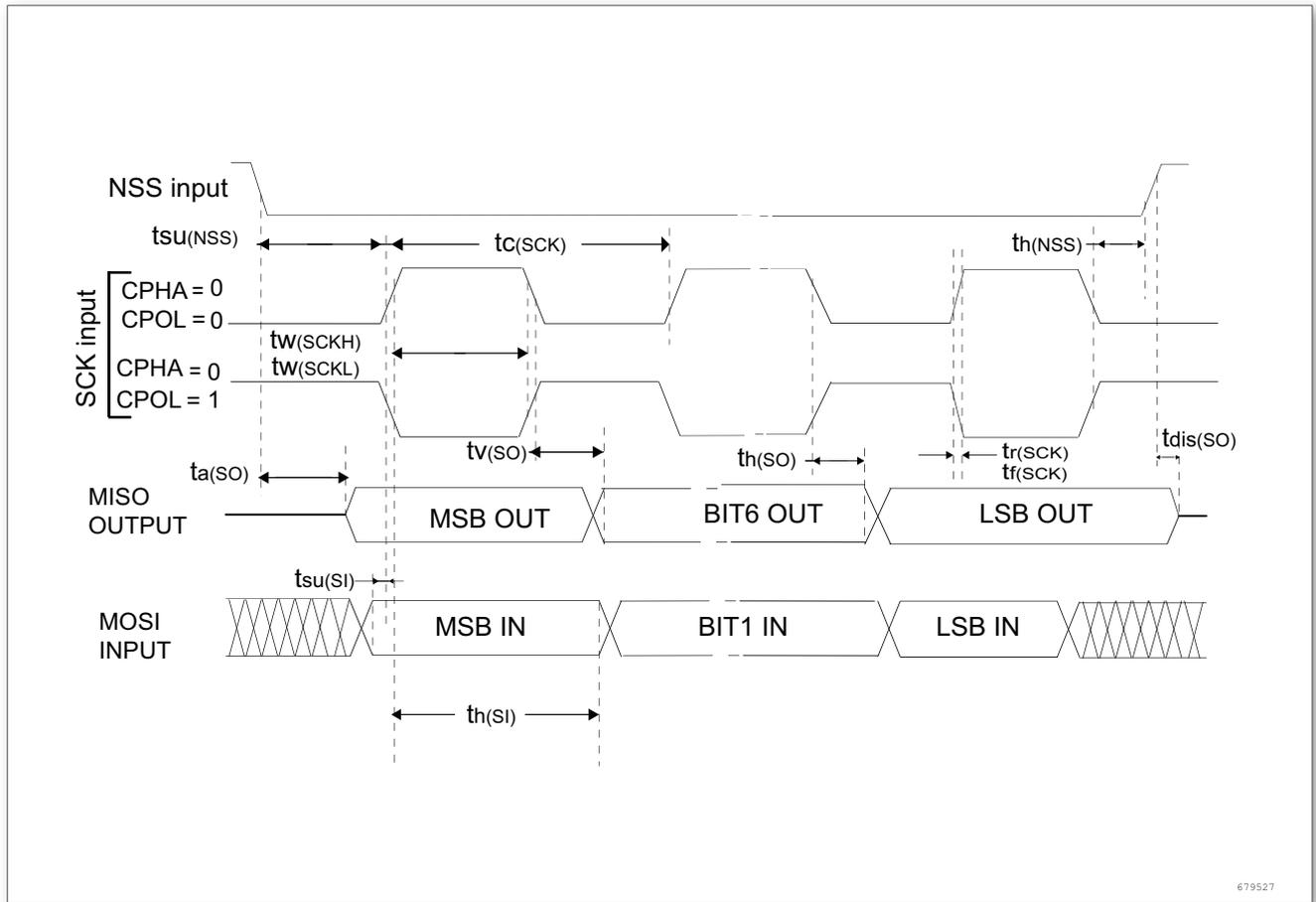
图 19. SPI 时序图 从模式和 CPHA = 0
