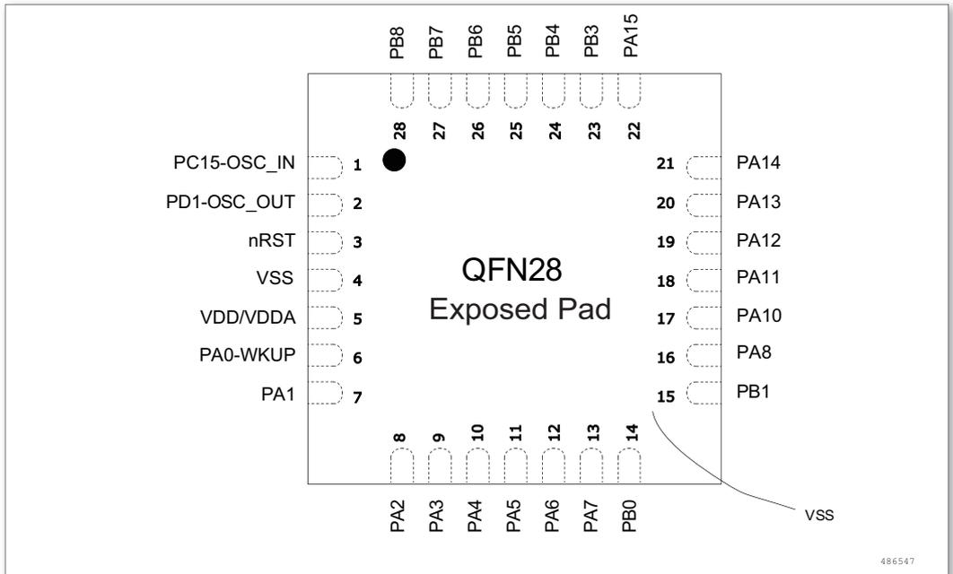
图 8. QFN28 引脚分布
