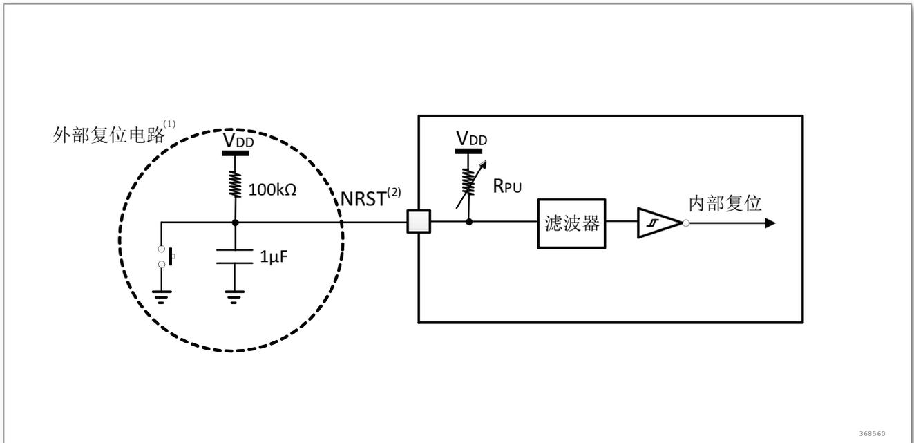
图 17. 建议的 NRST 引脚保护
