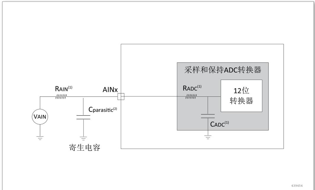
图 22. 使用 ADC 典型的连接图
