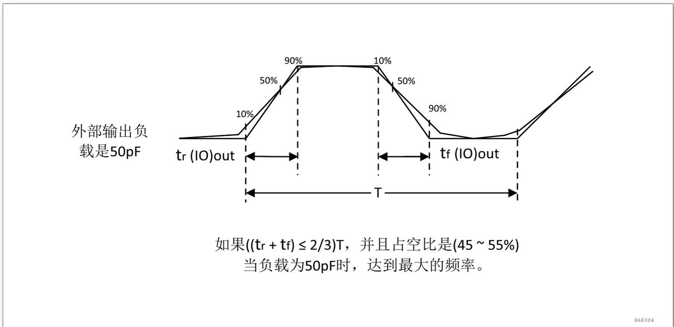
图 16. 输入输出交流特性定义
