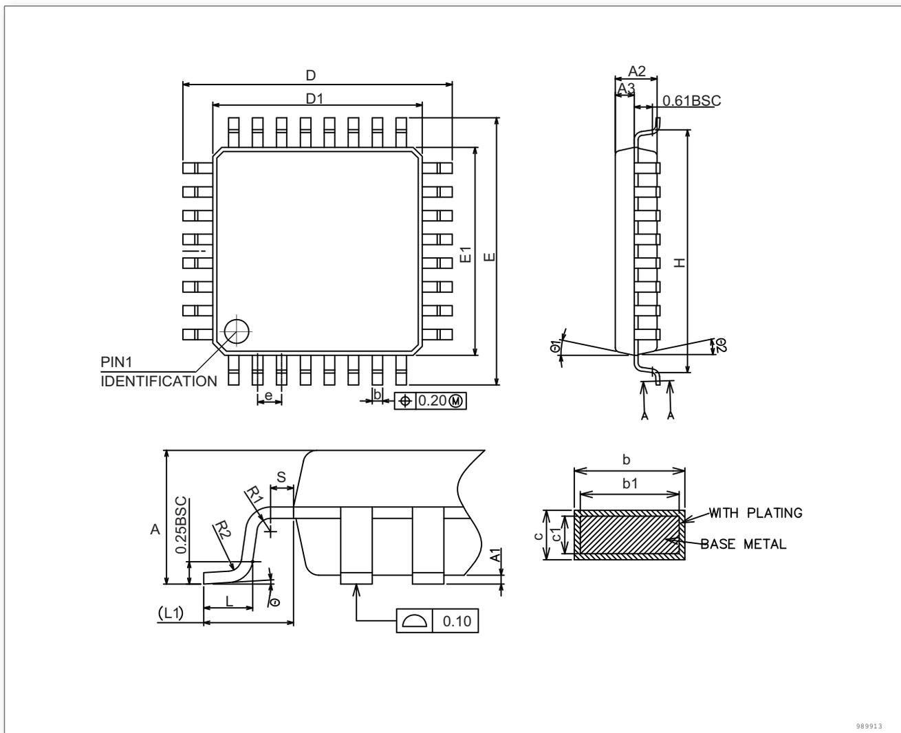
图 28. LQFP32, 32 脚低剖面方形扁平封装图
