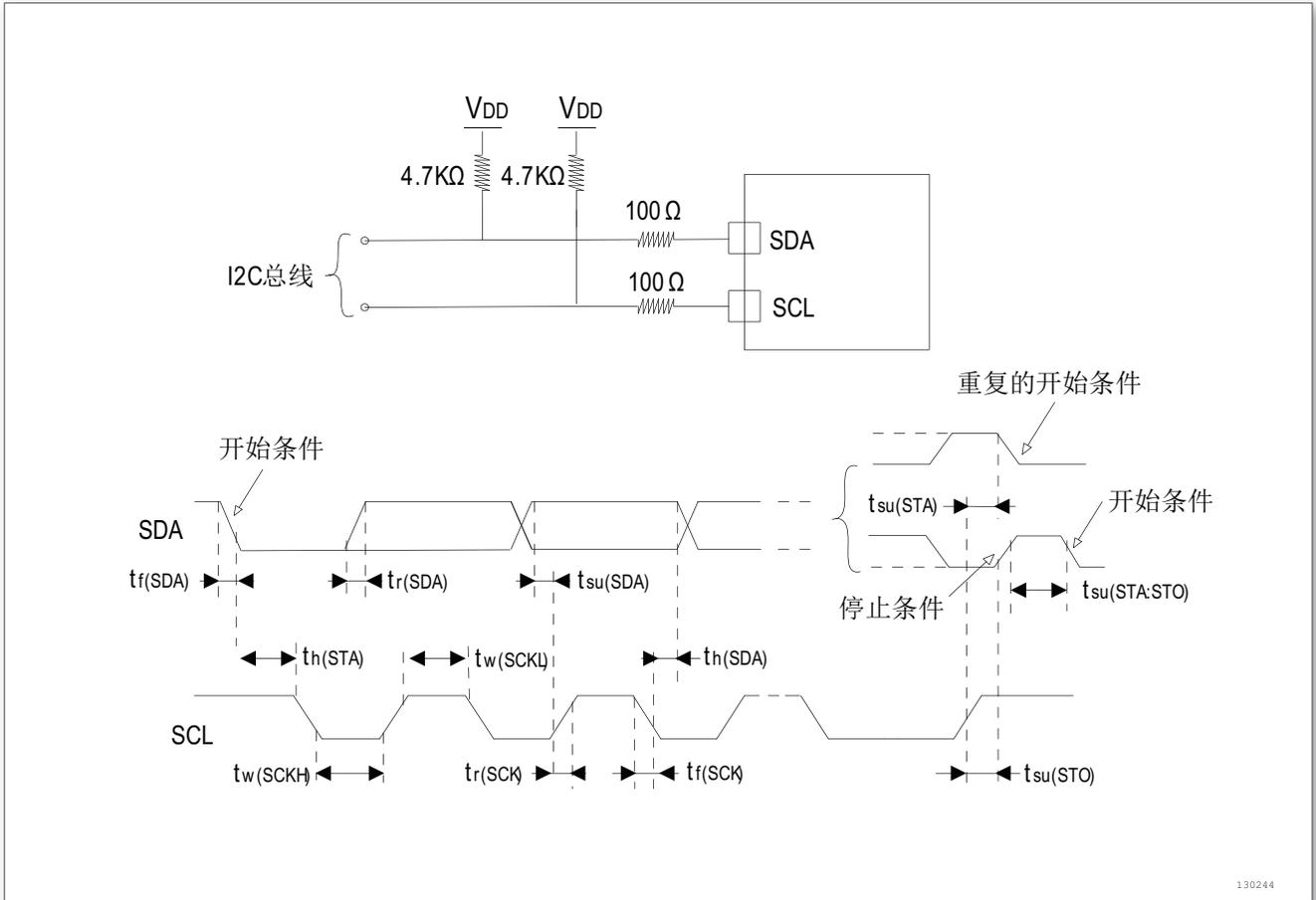
图 18. I2C 总线交流波形和测量电路<sup>(1)</sup>
