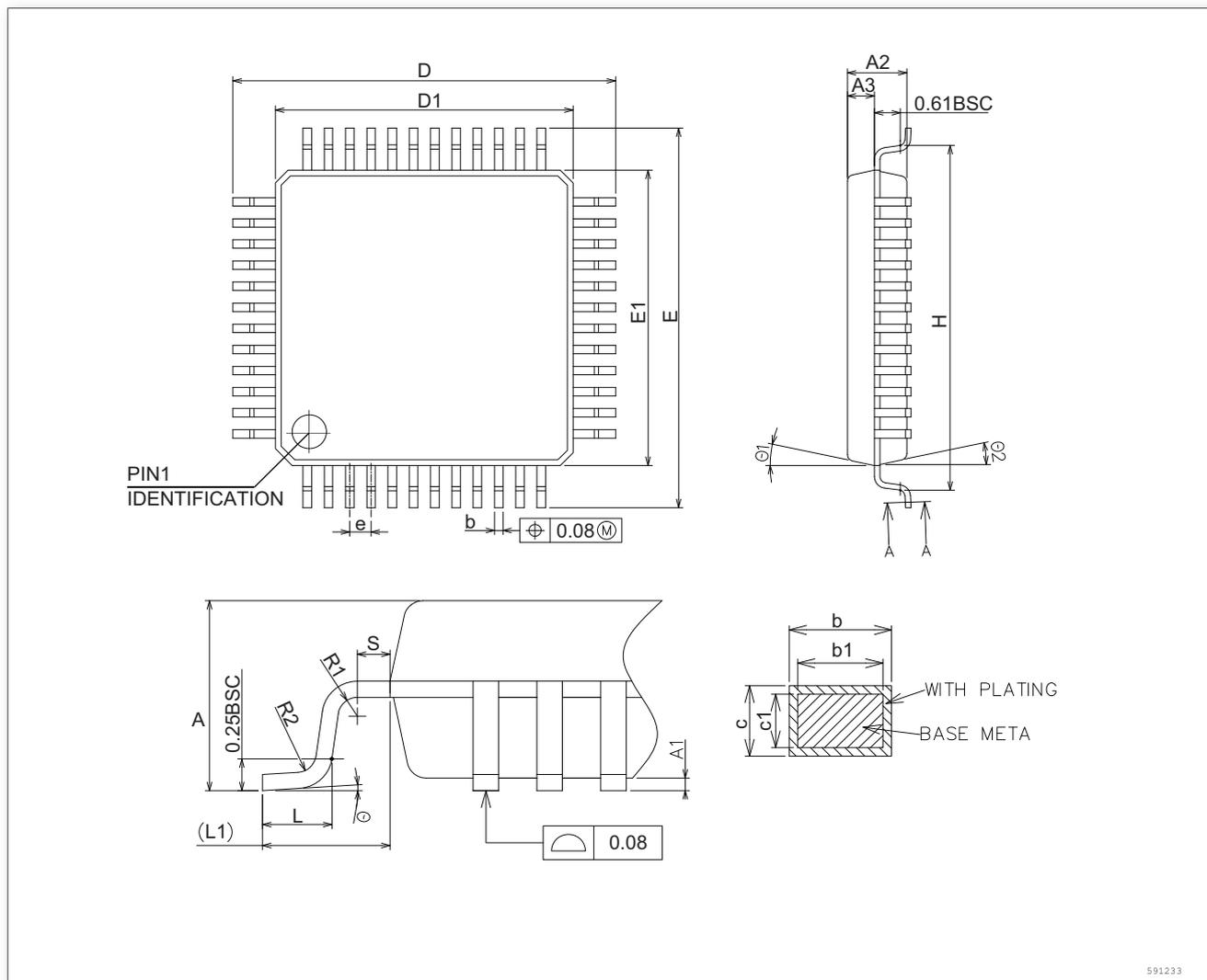
图 25. LQFP48, 48 脚低剖面方形扁平封装图
