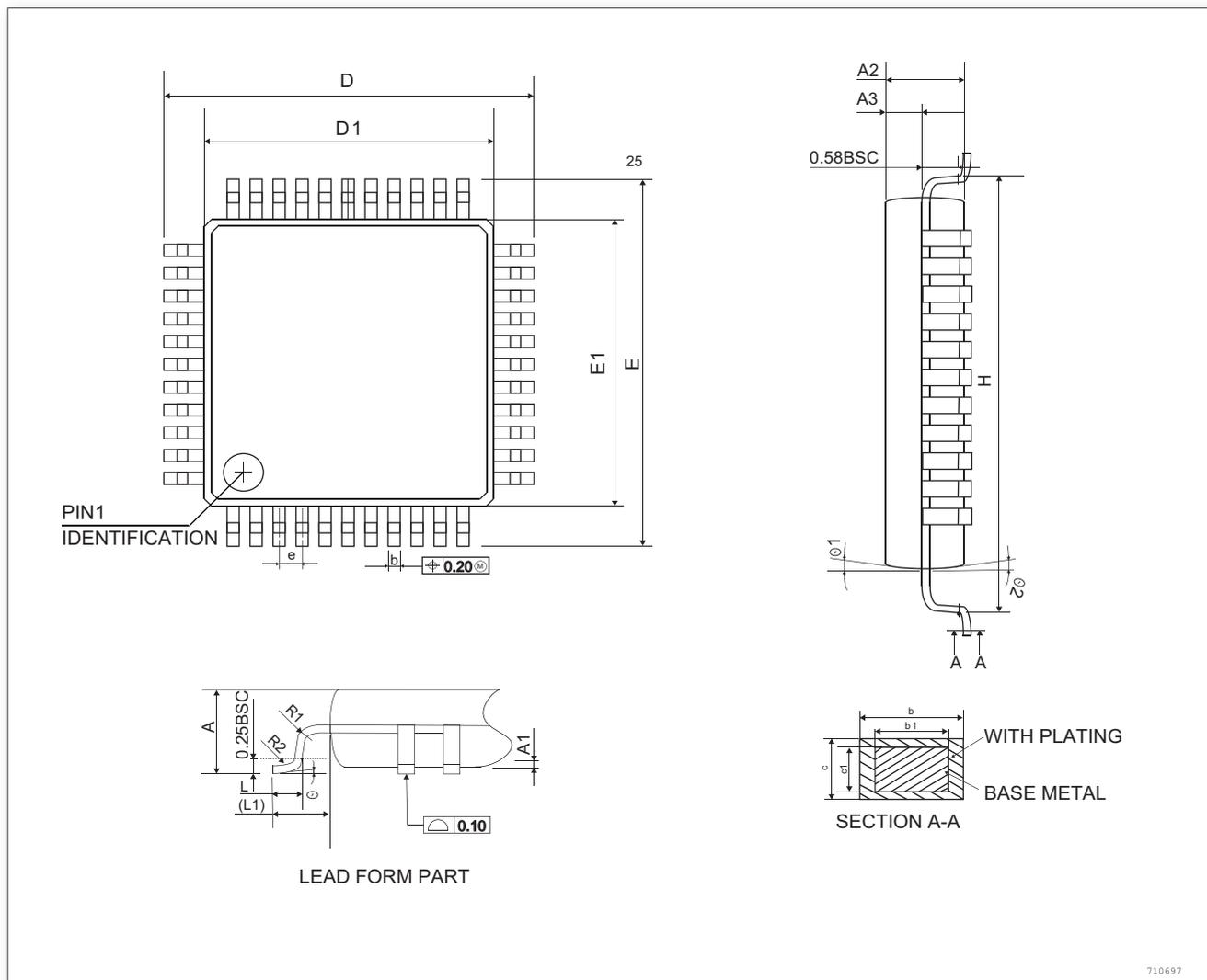
图 27. LQFP44, 44 脚低剖面方形扁平封装图
