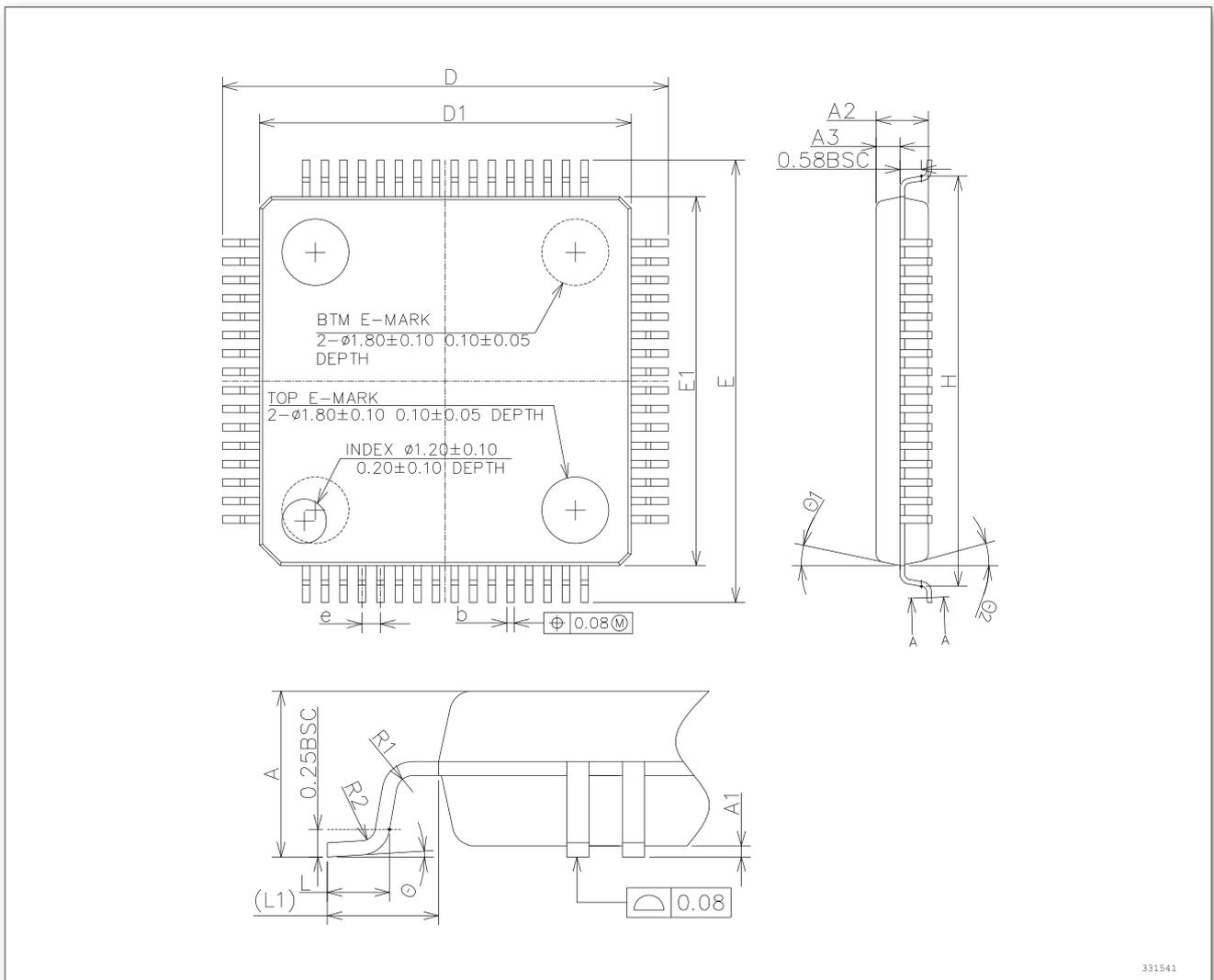
图 24. LQFP64, 64 脚低剖面方形扁平封装图
