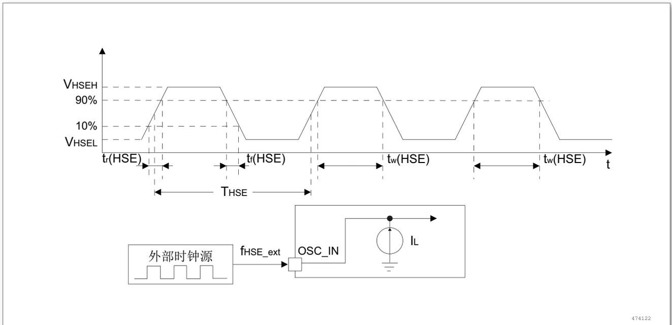
图 14. 外部高速时钟源的交流时序图
