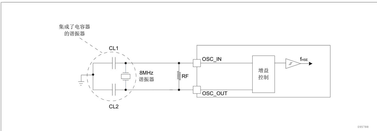
图 15. 使用 8MHz 晶体的典型应用
