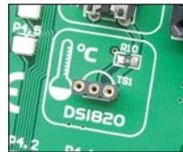
**Figure 8-1:** DS1820 connector (DS1820 is not placed)
