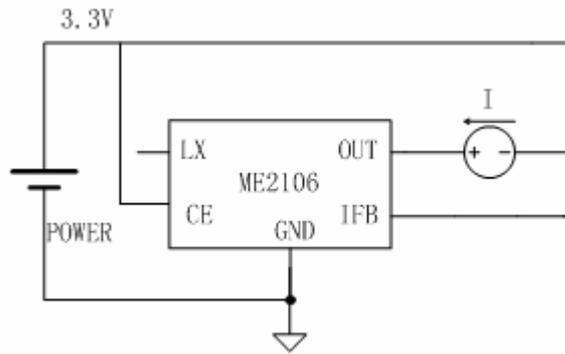
(5) 测试振荡频率和占空比电路
