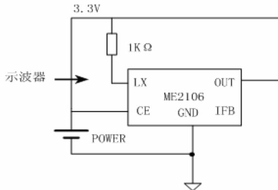
(6) 测试开关管合闸电流
