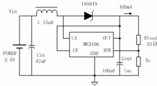
(2) 测试启动电压电路
