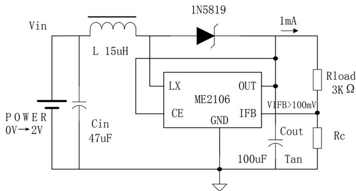
(3) 测试保持电压电路
