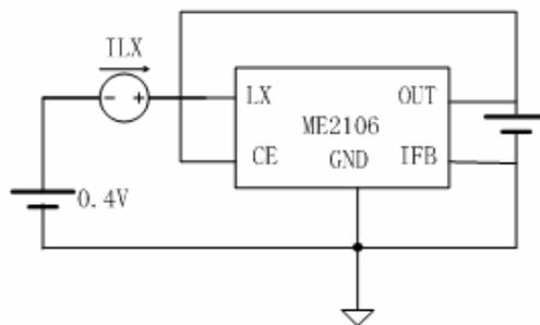
(7) 测试开关管漏电流
