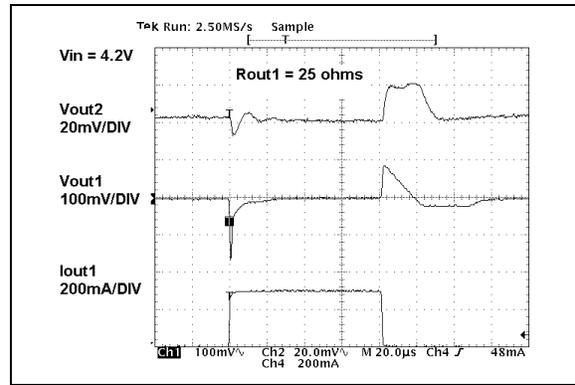
**FIGURE 2-24:** 300 mA Dynamic Load Step  $V_{OUT1}$ .
