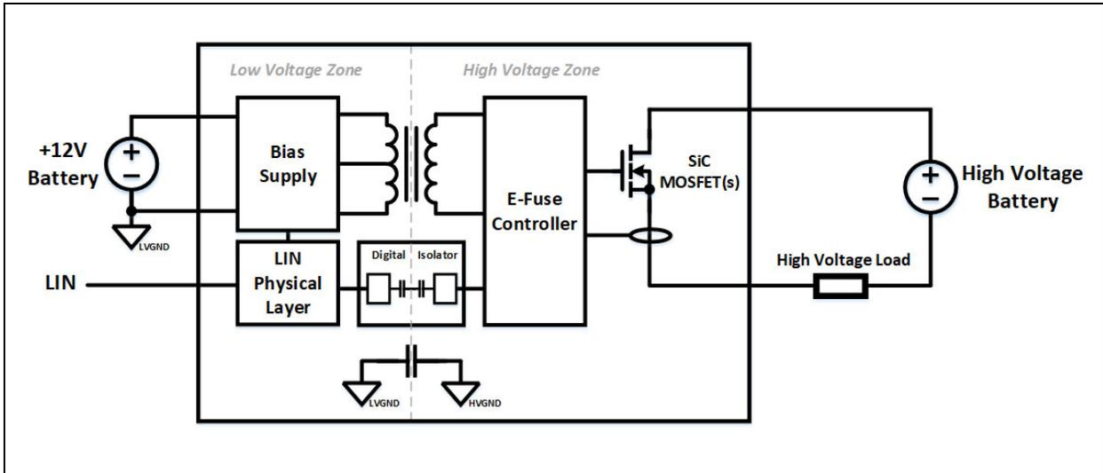
**FIGURE 1-1:** LV-HV Block Diagram.
