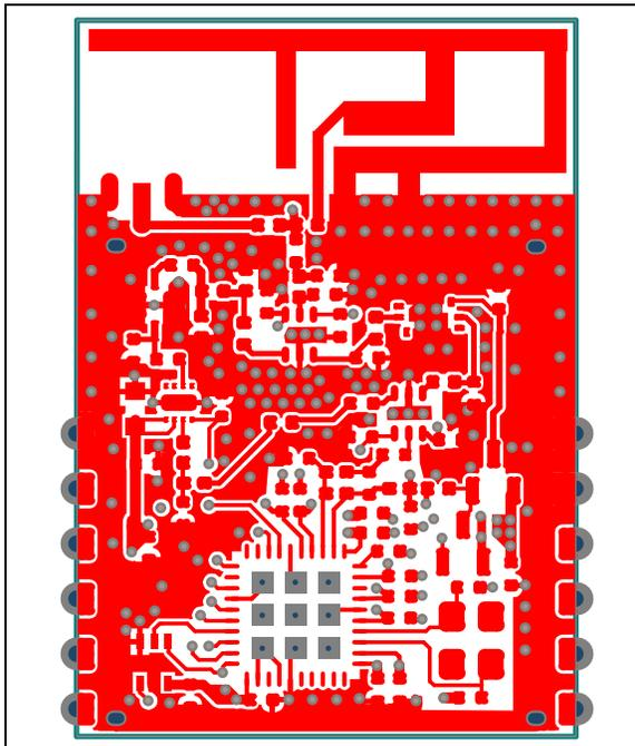
FIGURE 2-8: LAYER 2 – GROUND PLANE
