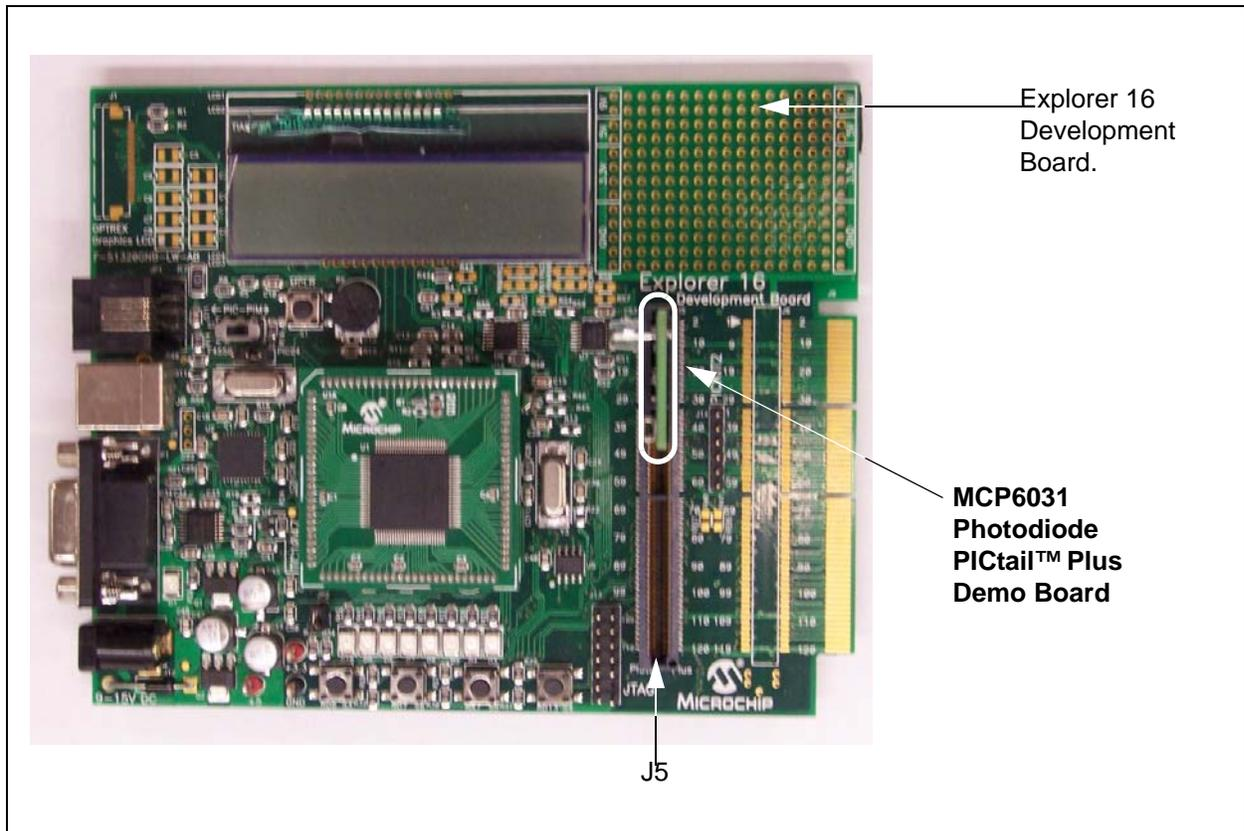
**FIGURE 2-1:** MCP6031 Photodiode PICtail™ Plus Demo Board Set-Up.
