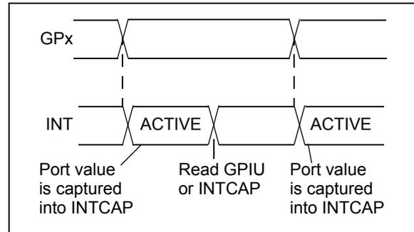
**FIGURE 1-7: INTERRUPT-ON-CHANGE FROM REGISTER DEFAULT**
