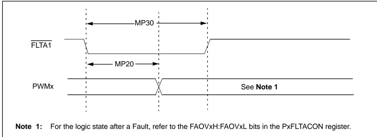
**FIGURE 26-10: MOTOR CONTROL PWM MODULE TIMING CHARACTERISTICS**
