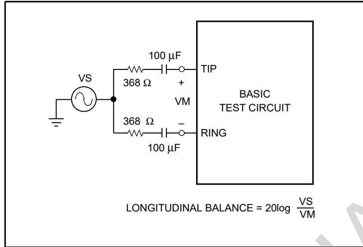
**Figure 8 - Longitudinal Balance**
