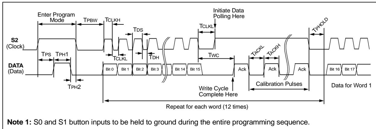
**FIGURE 6-2: VERIFY WAVEFORMS**
