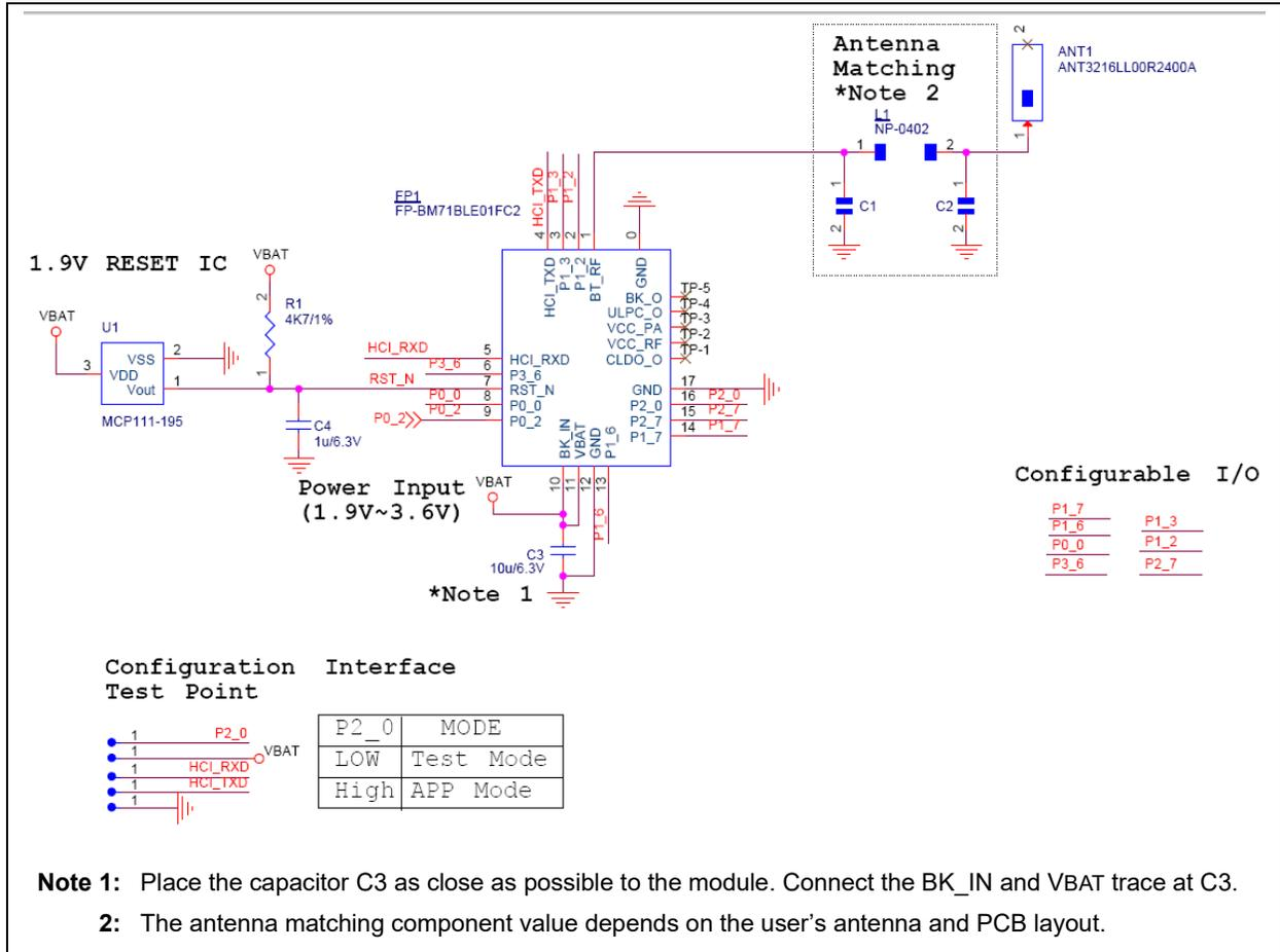
**FIGURE 2-6: BM71BLE01FC2 REFERENCE CIRCUIT**
