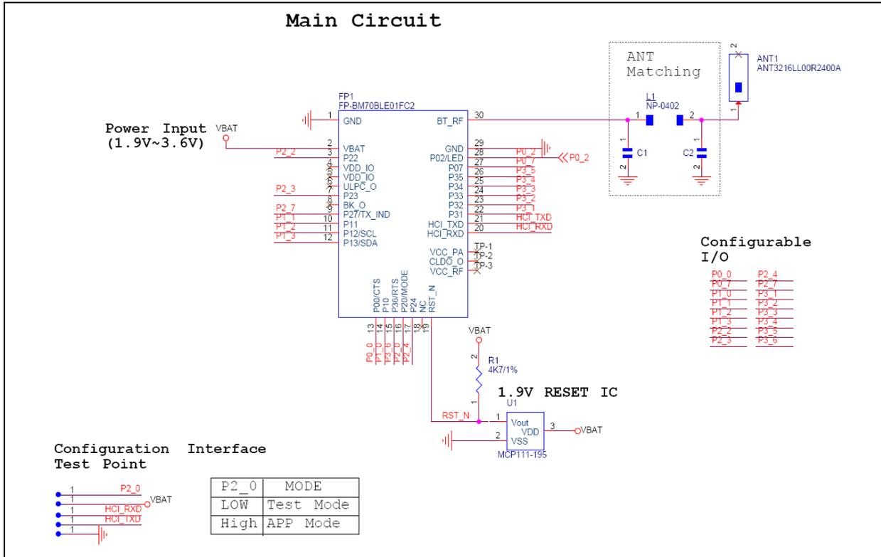
**FIGURE 2-4: BM70BLE01FC2 REFERENCE CIRCUIT**
