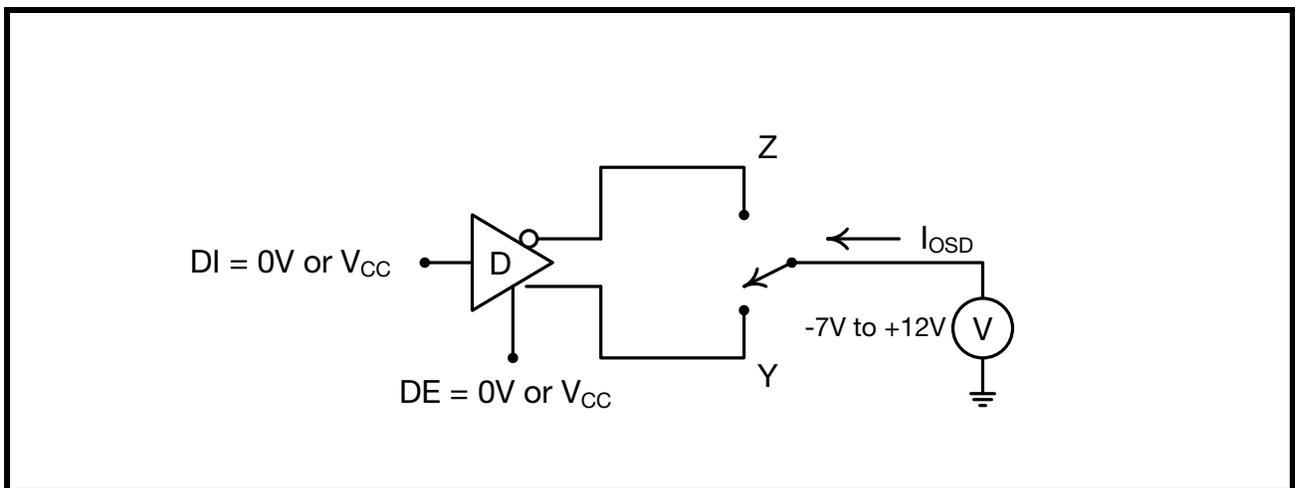
FIGURE 5. TRANSIENT OVER-VOLTAGE TEST CIRCUIT
