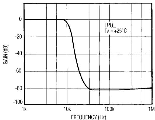
**FILTER RESPONSE USING TYPICAL OPERATING CIRCUIT**
