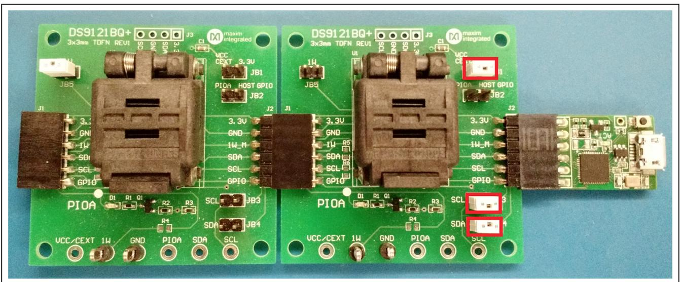
Figure 3. DS2477 Connected to DS9481P-300# and DS28E16
