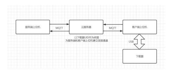
云服务器远程下载连接示意图
