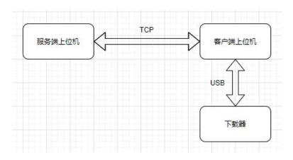
TCP 远程下载连接示意图
