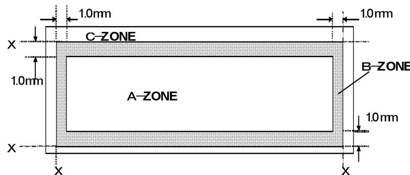
X : Maximum Seal Line. (図面によるシール許容基準線)
