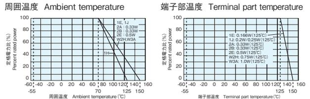
周囲温度70℃以上で使用される場合は、上図負荷軽減曲線に従って、定格電力を軽減して御使用ください。
