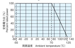
周囲温度70℃以上で使用される場合は、左図負荷軽減曲線に従って、定格電力を軽減して御使用ください。
