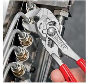
The mini pliers wrench for precision mechanics
