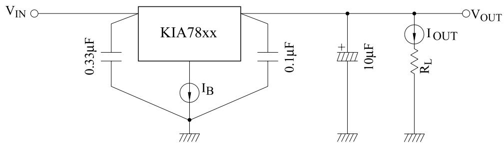
Fig. 2  $V_{NO}$  Test Circuit
