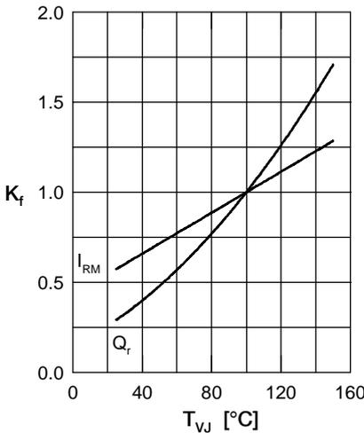
Fig. 4 Dynamic parameters  $Q_r$ ,  $I_{RM}$  versus  $T_{VJ}$
