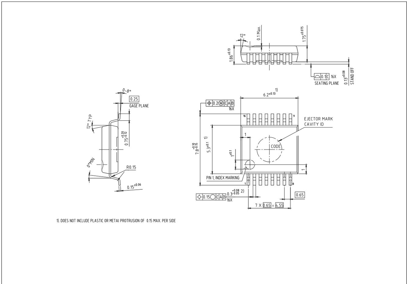
Figure 51 PG-SSOP-16<sup>1)</sup>
