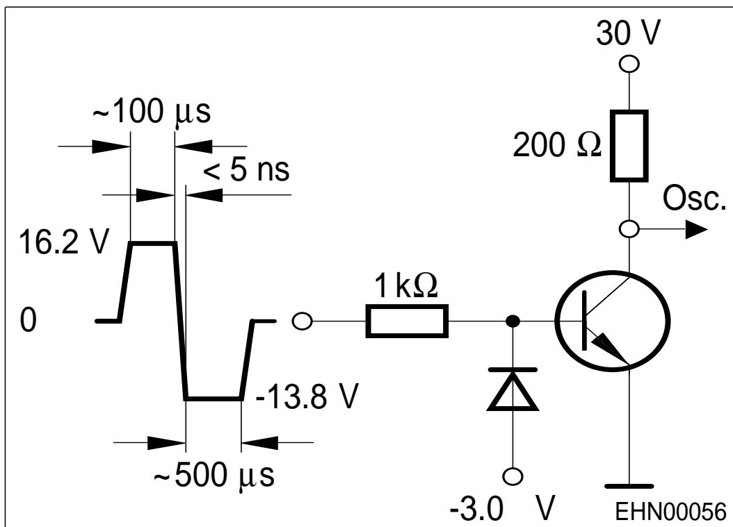
**Oscillograph:**  $R > 100\Omega$ ,  $C < 12\text{pF}$ ,  $t_r < 5\text{ns}$
