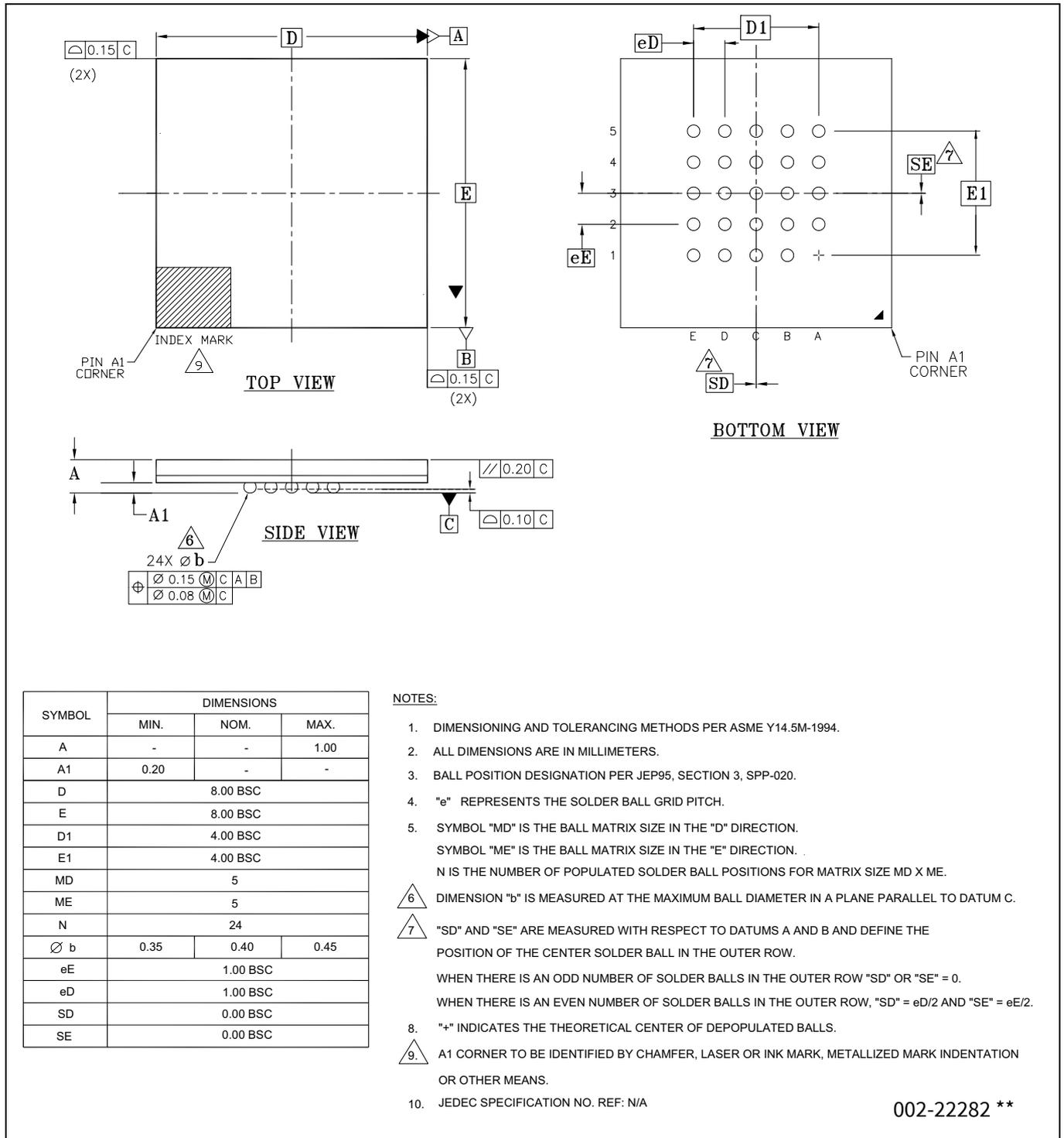
Figure 83 ボールグリッドアレイ 24ボール 8x8mm (VAC024)
