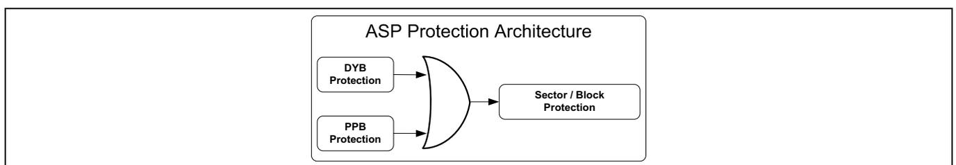
Figure 46 DYB と PPB の保護制御
