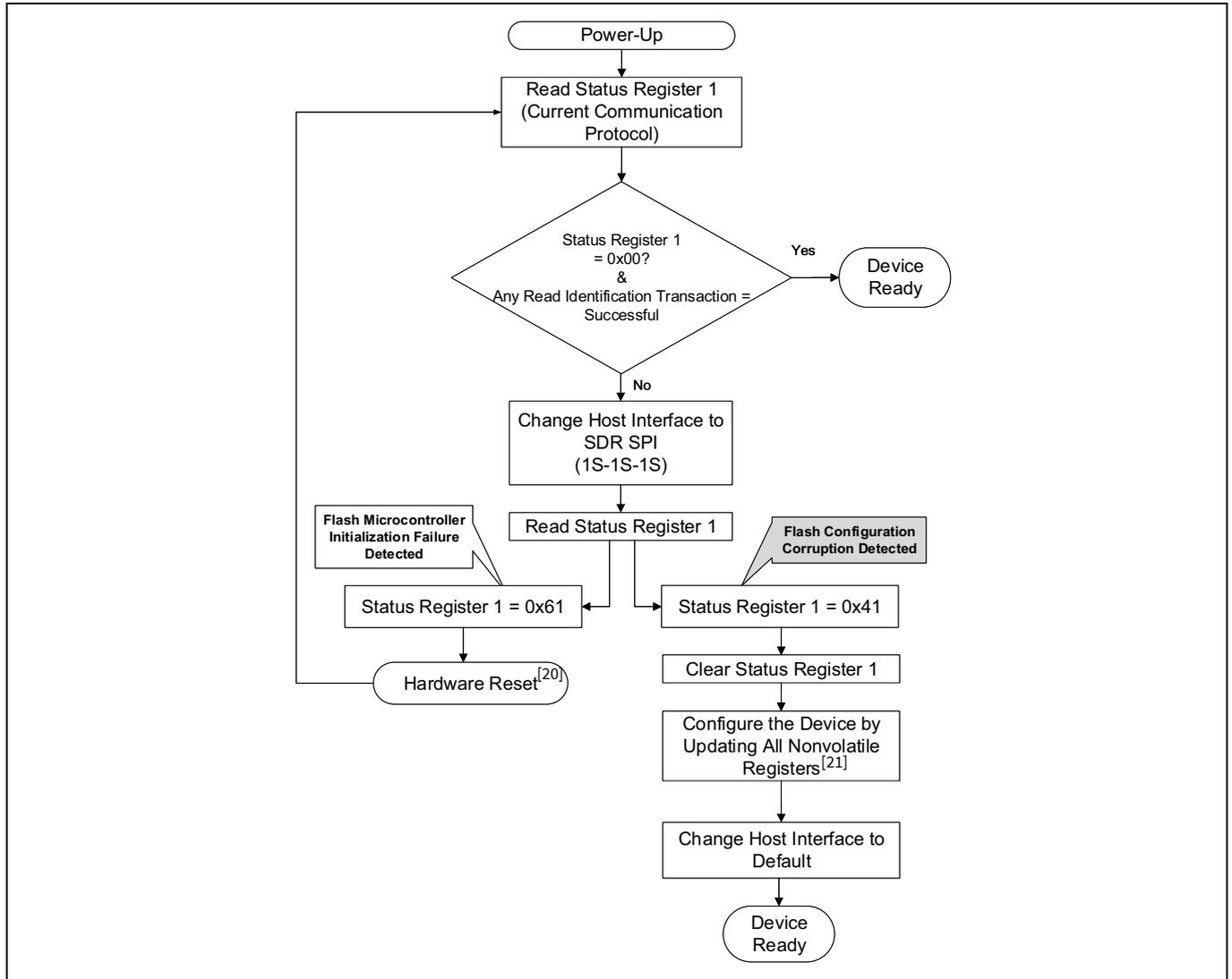
Figure 54 コンフィギュレーション破損検出用のホストポーリングシーケンス
