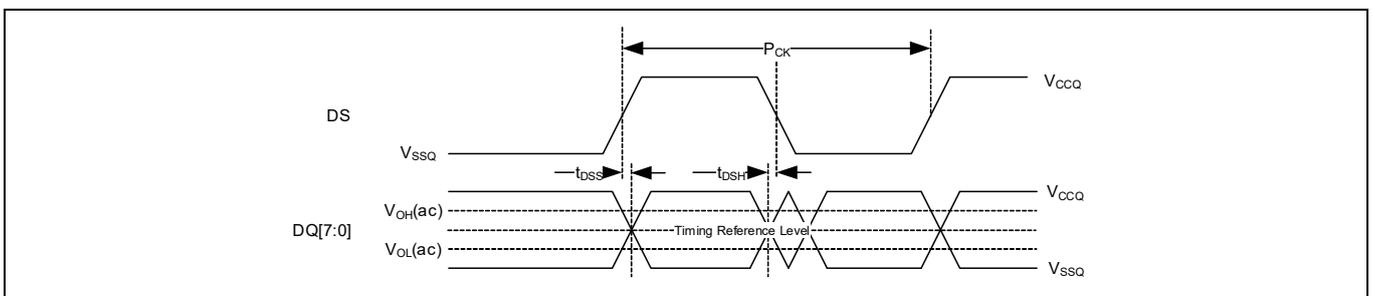
Figure 75 DDR 出力タイミング参照レベル
