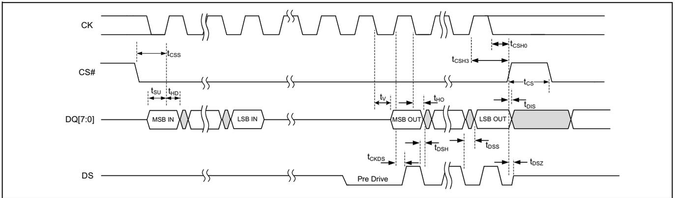
Figure 79 オクタル SDR 入力と出力タイミング
