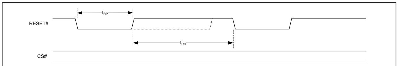
Figure 58 RESET# 入力によるハードウェアリセット (連続したハードウェアリセット)
