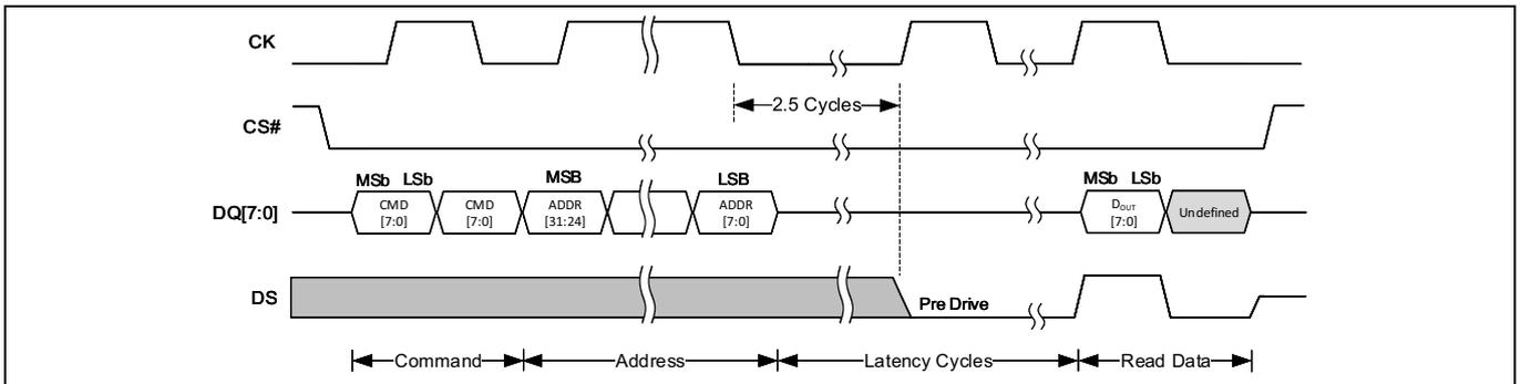
Figure 29 コマンドとアドレス入力のあるオクタル DDR シングルバイト読み出しトランザクション (出力レイテンシ有り)<sup>[6]</sup>
