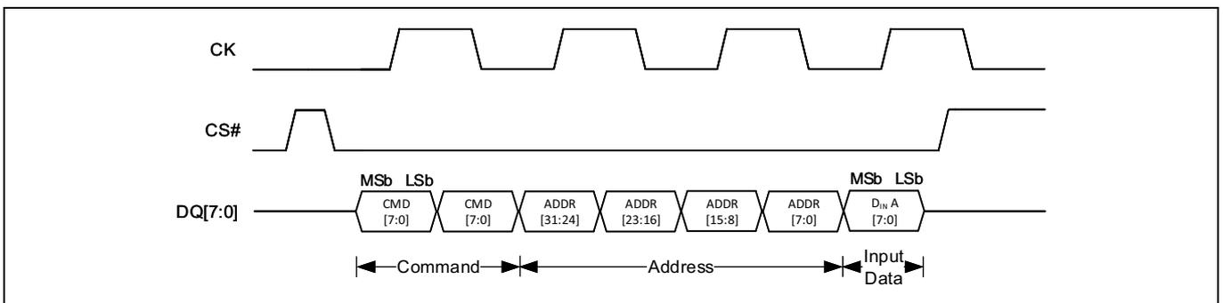
Figure 26 コマンド、アドレスおよびシングルバイト データ入力のあるオクタル DDR プログラム トランザクション<sup>[3]</sup>
