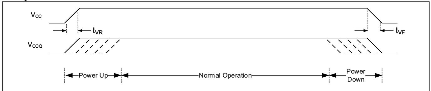
Figure 66 電源投入と電源切断シーケンス
