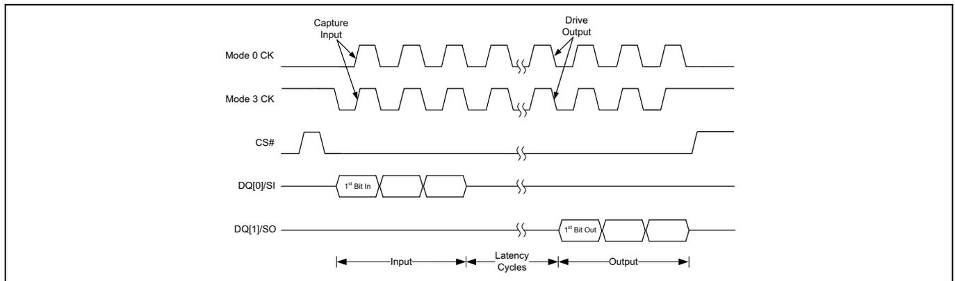
Figure 3 サポートされる SPI SDR モード
