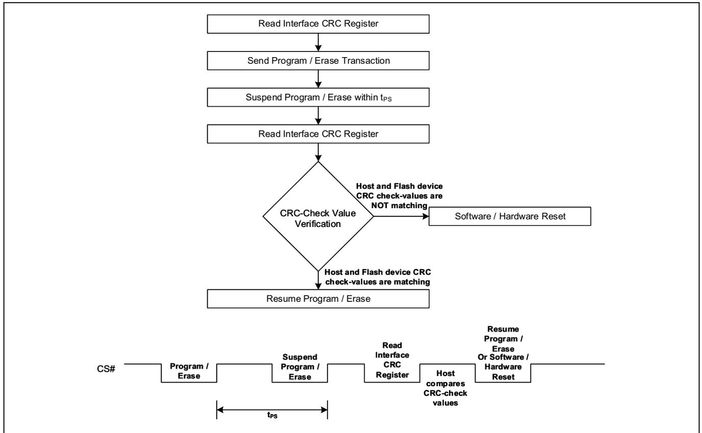
Figure 42 プログラムおよび消去トランザクションのインターフェース CRC フロー
