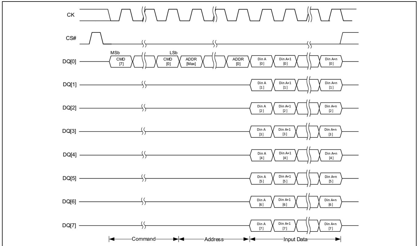
Figure 15 コマンド, アドレスとオクタル出力のある SPI 読み出しトランザクション (1S-1S-8S)
