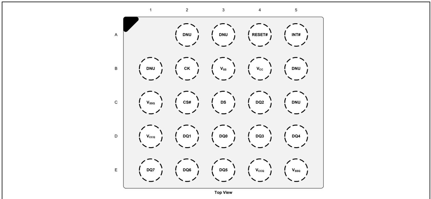
Figure 1 24 ボール BGA ピン配置 [1]
