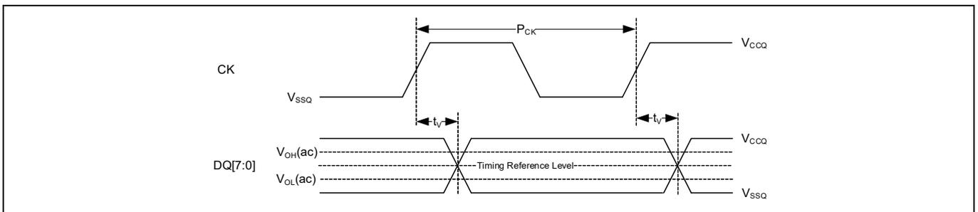
Figure 74 SDR 出力タイミング参照レベル
