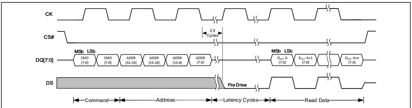
Figure 28 コマンドとアドレス入力のあるオクタル DDR 読み出しトランザクション (出力レイテンシ有り)<sup>[4, 5]</sup>
