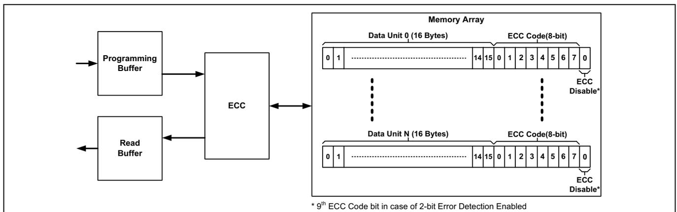
Figure 36 16 バイト ECC データユニットの例
