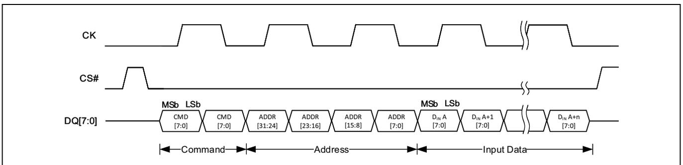
Figure 25 コマンド、アドレスおよびデータ入力のあるオクタル DDR プログラム トランザクション<sup>[3]</sup>
