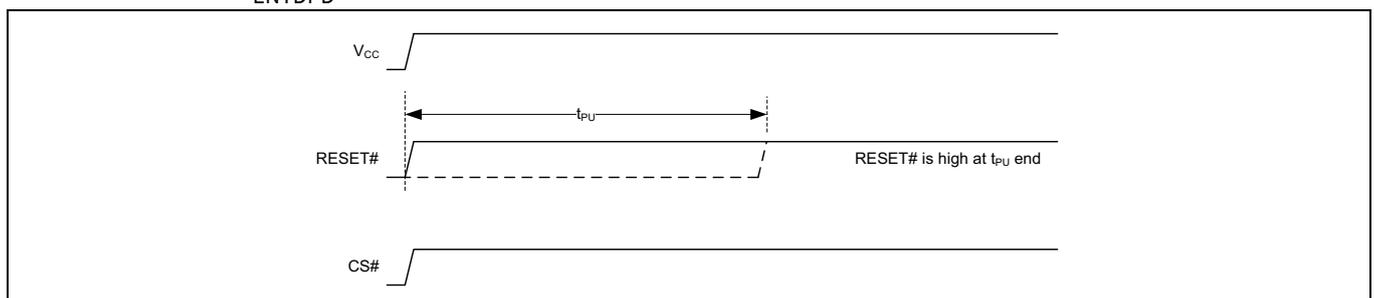
Figure 62 電源投入またはリセットによる DPD モード開始
