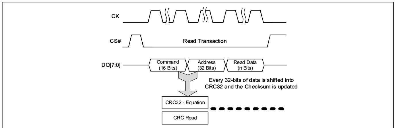
Figure 40 CRC による読み出し保護
