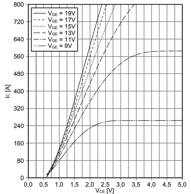
**Übertragungscharakteristik IGBT, Wechselrichter (typisch)**
