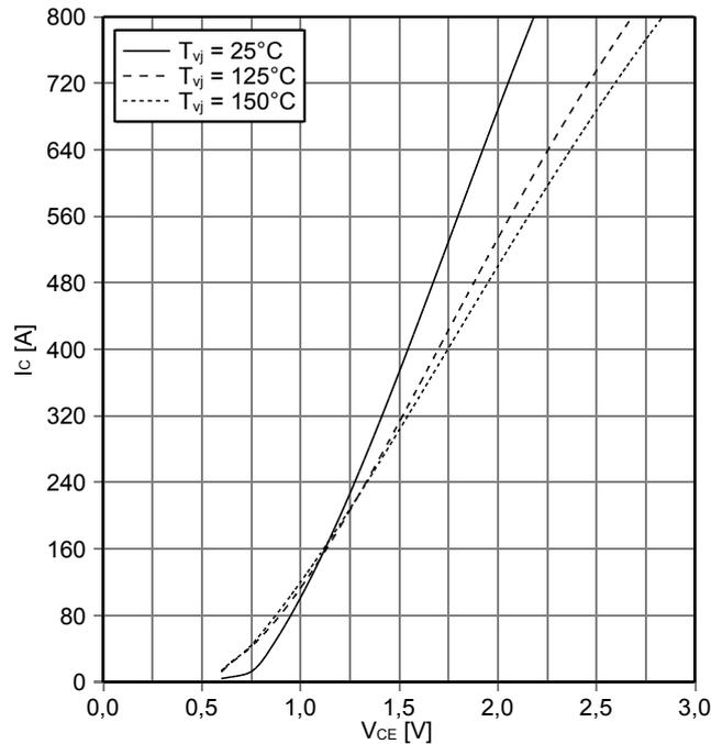
**Ausgangskennlinienfeld IGBT, Wechselrichter (typisch)**
