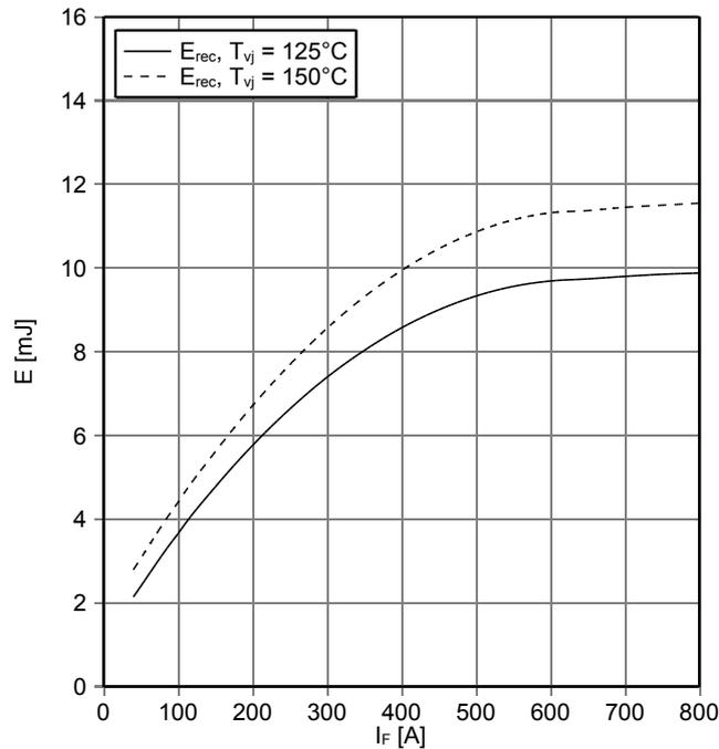
**Schaltverluste Diode, Wechselrichter (typisch)**
