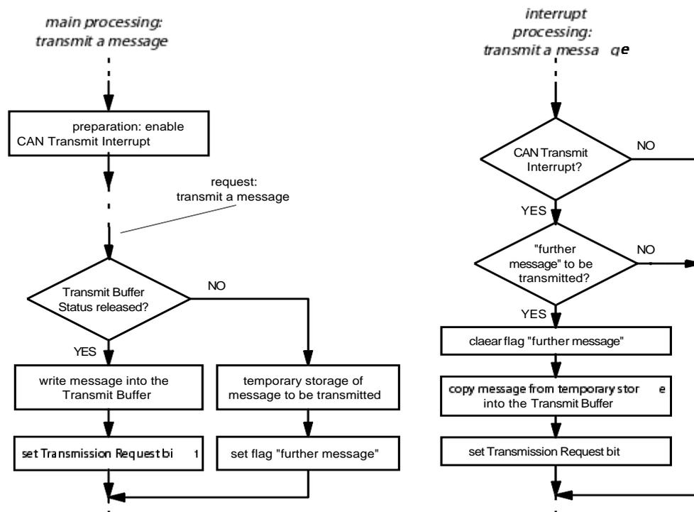
图 13 “发送一个报文”的流程(中断控制)
