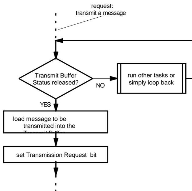
图 14 “发送一个报文” 的流程 (查询控制 )
