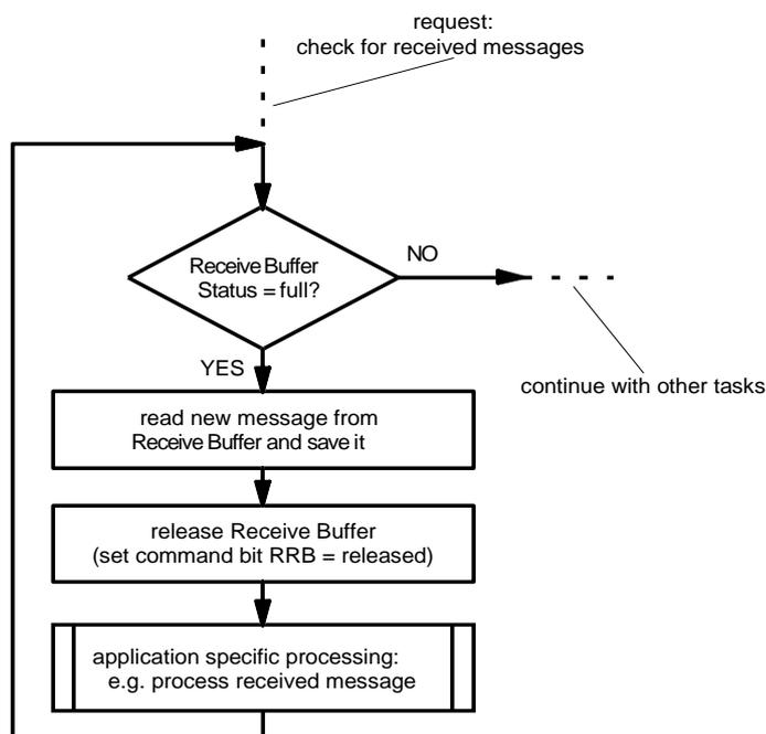
图 17 “接收一个报文”的流程（中断控制）
