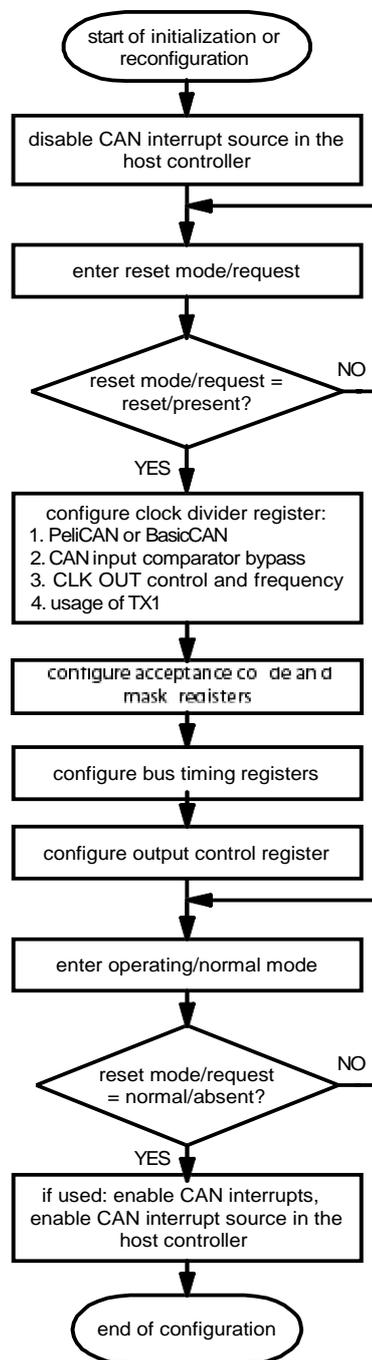
图 12 “HT1000A 的初始化”流程图
