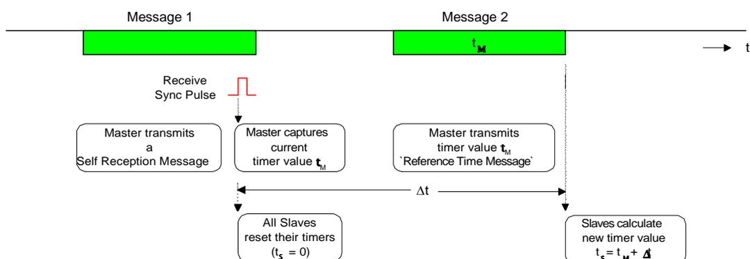
图 29 系统同步的时序图
