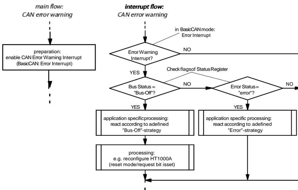
图 21 “出错中断” 的流程图
