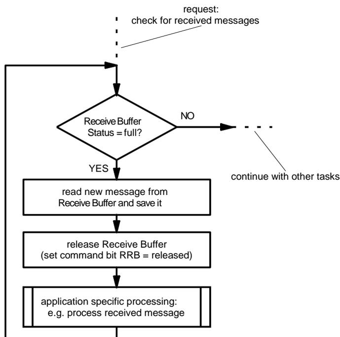
图 16 “接收一个报文”的流程（查询控制）
