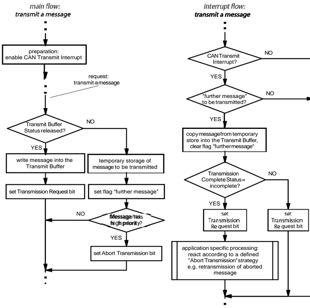
图 15 “中止发送一个报文”的流程（中断控制）
