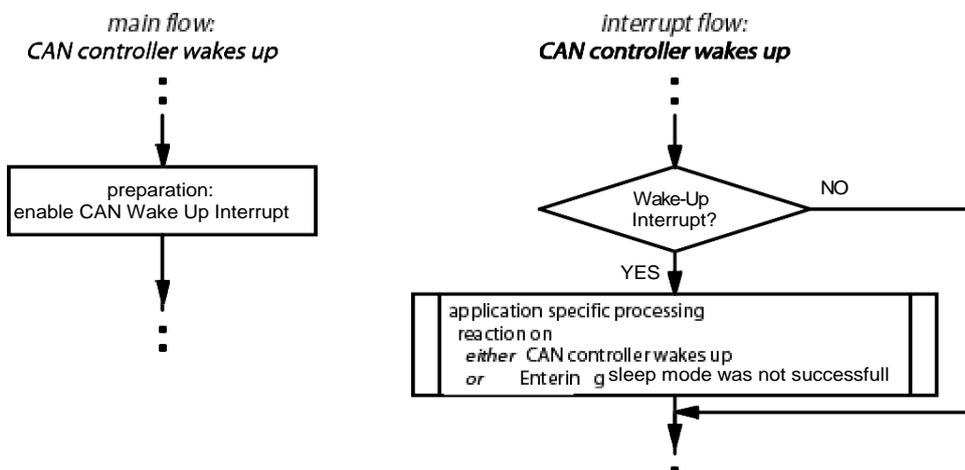
图 20 “CAN 控制器唤醒” 的流程图
