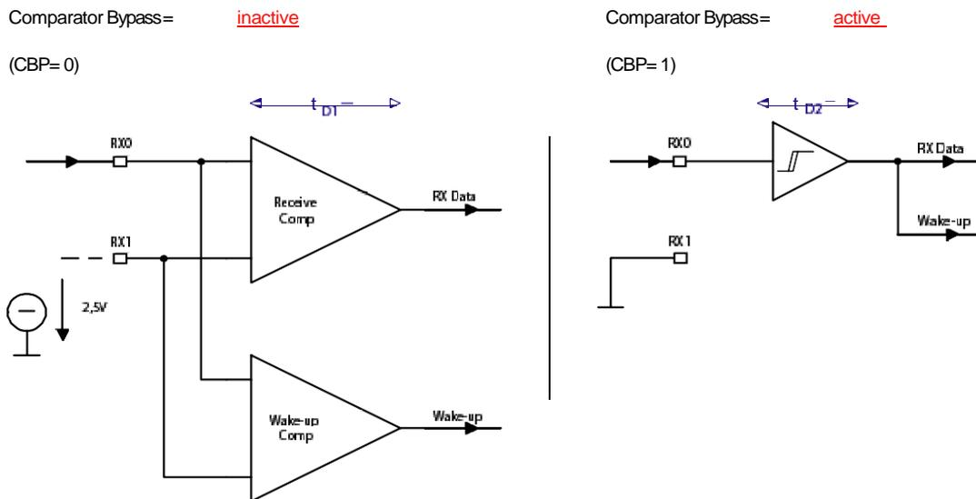
图 6 HT1000A 的接收输入比较器
