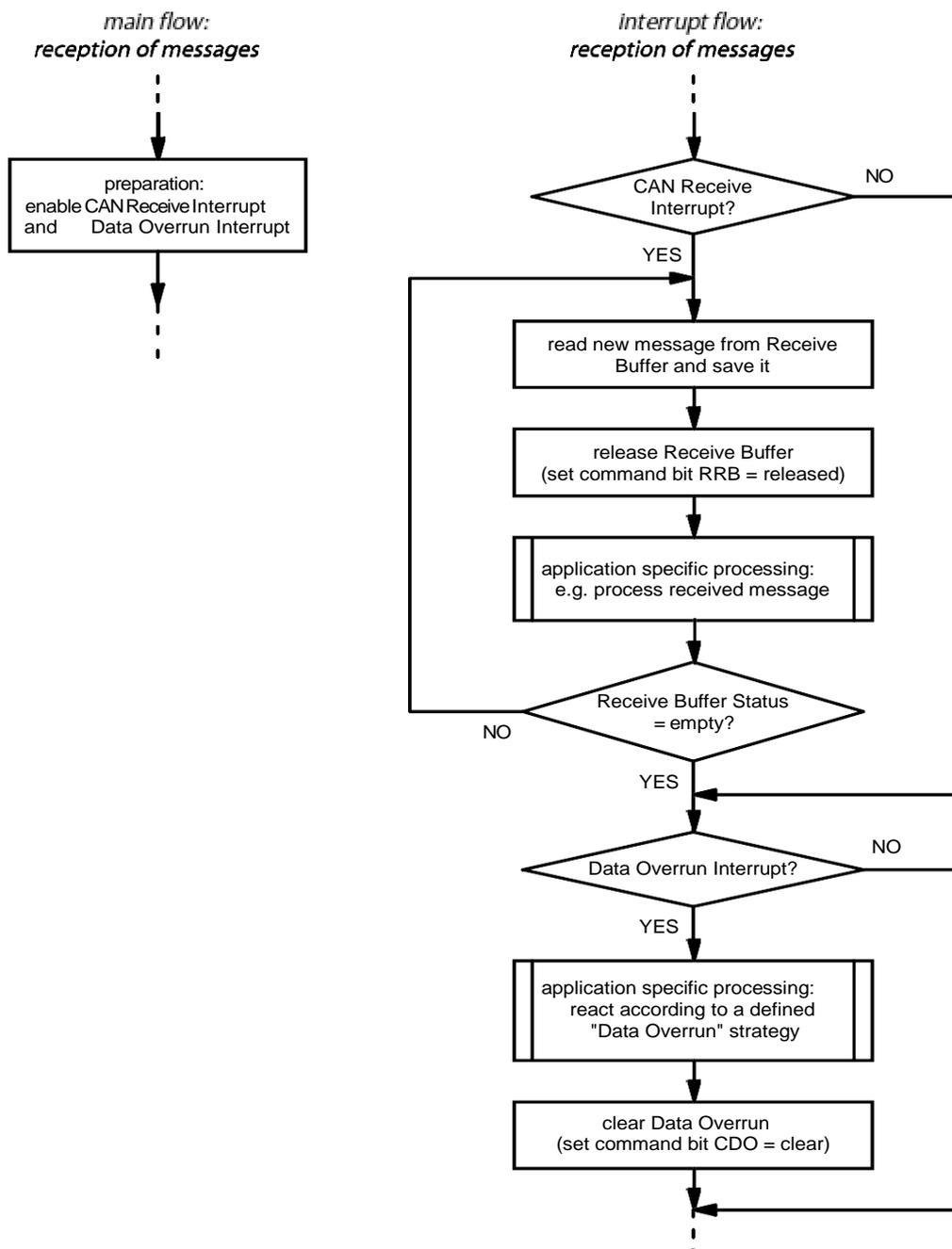
图 18 “数据超载和接收报文” 的流程（中断控制）
