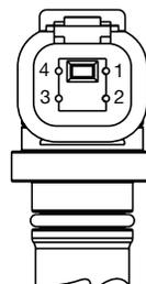
**Deutsch DTM04-4P Pinout**
