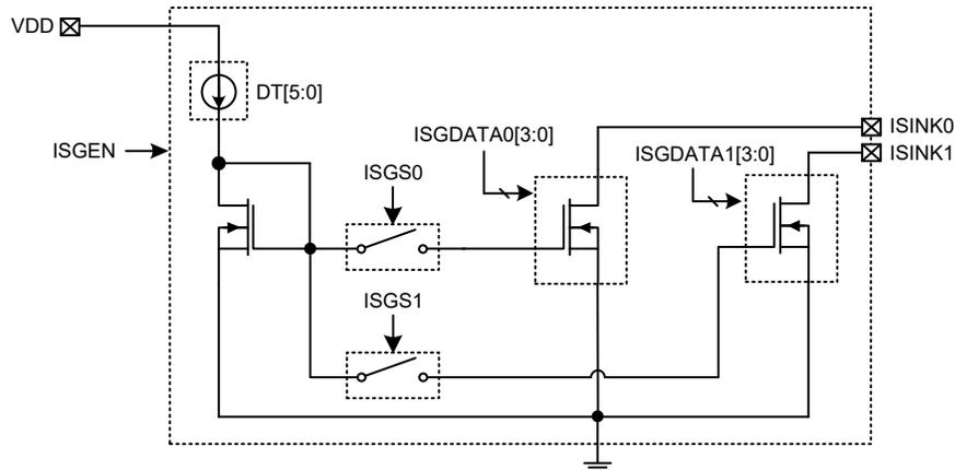
注：在 8-pin SOP/16-pin NSOP-A 封装中 ISINK0 和 ISINK1 打在同一引脚位置，或者在 16-pin NSOP-B 封装中，这两个引脚被用户自行外部接在一起使用时，若 ISGS0/ISGS1=0，则对应的 ISGDATA0/ISGDATA1 寄存器必须清零，以避免漏电流情况发生。
