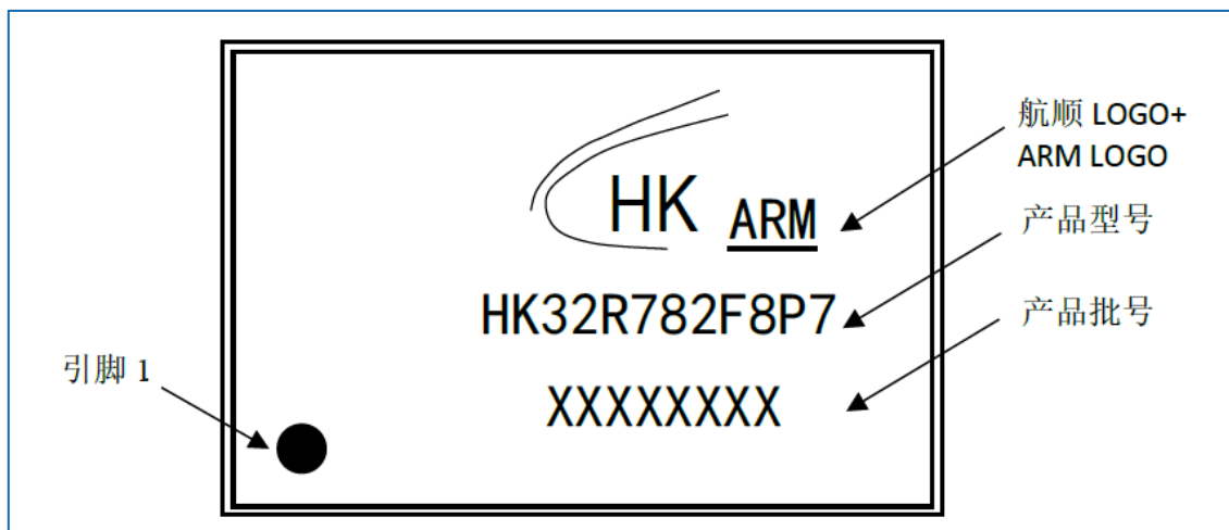
图 7-8 TSSOP20 丝印示例
