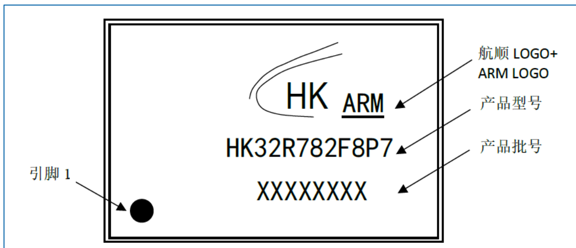
图 7-8 TSSOP20 丝印示例
