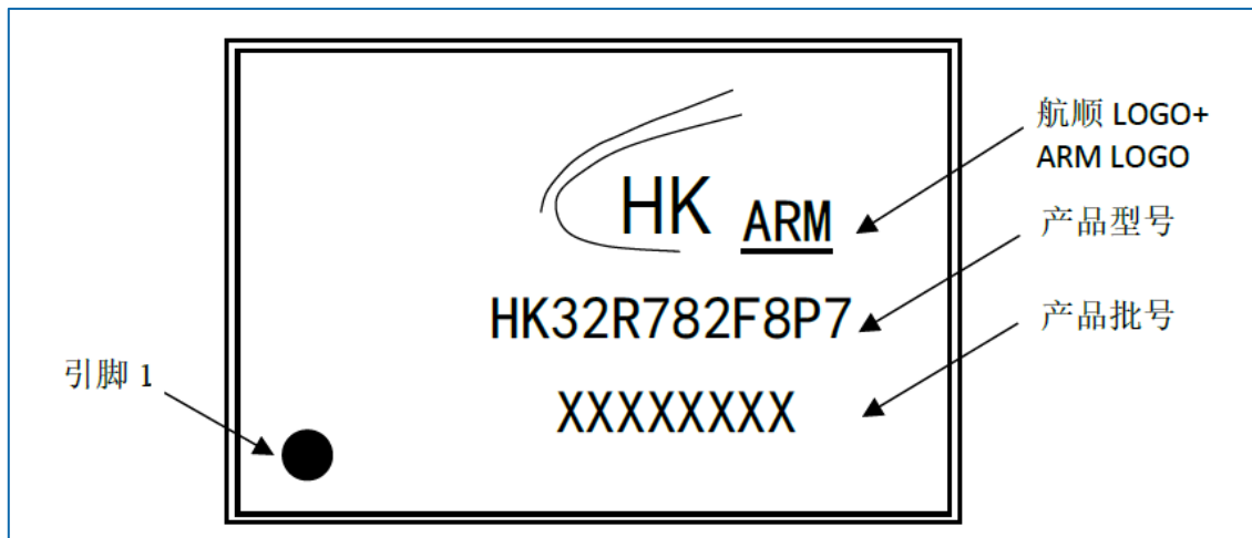
图 7-8 TSSOP20 丝印示例
