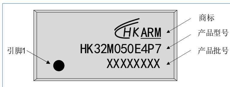
图 7-9 TSSOP24 HK32M050E4P7 丝印示例
