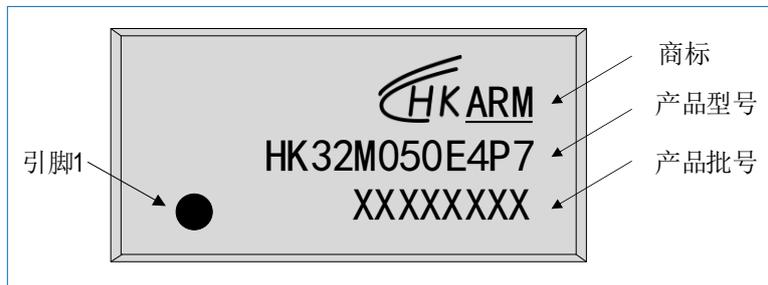
图 7-9 TSSOP24 HK32M050E4P7 丝印示例
