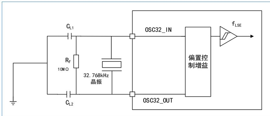
图 4-3 LSE 负反馈晶体振荡电路
