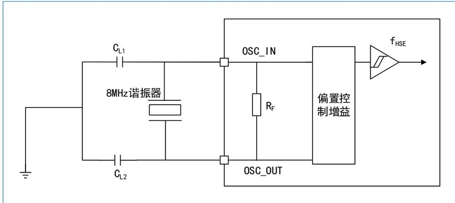
图 4-2 HSE 负反馈晶体振荡电路
