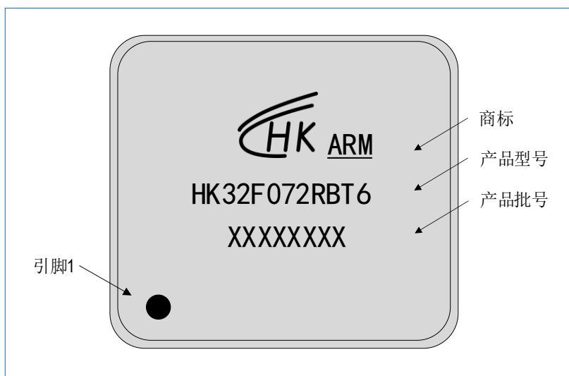
图 7-4 LQFP64 HK32F072RBT6 丝印示例
