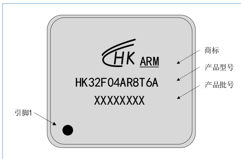
图 7-8 LQFP64 HK32F04AR8T6A 丝印示例
