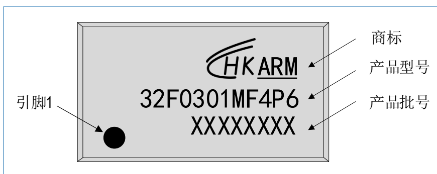
图 7-10 TSSOP20 HK32F0301MF4P6 丝印示例
