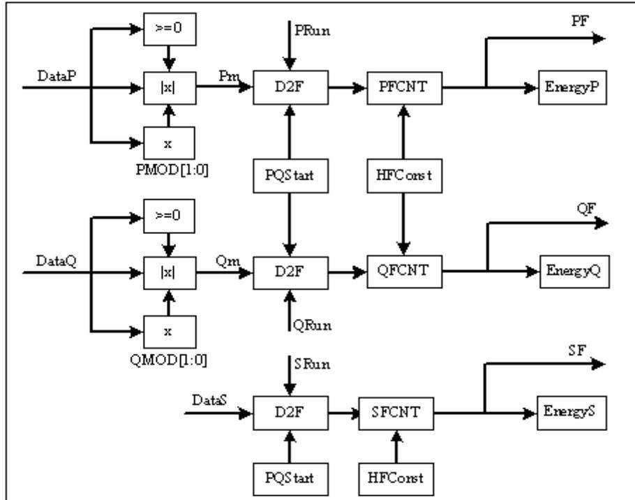
图 22-2-3 能量计量和脉冲输出
