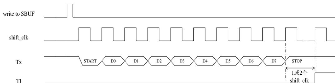
图示：方式 3 时串行发送数据时序
