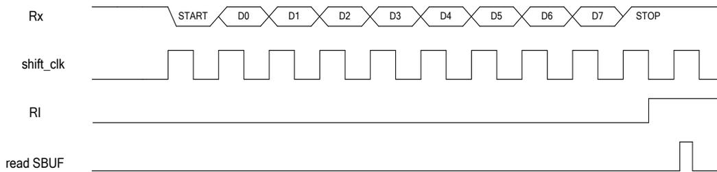
图示：方式 3 时串行接收数据时序
