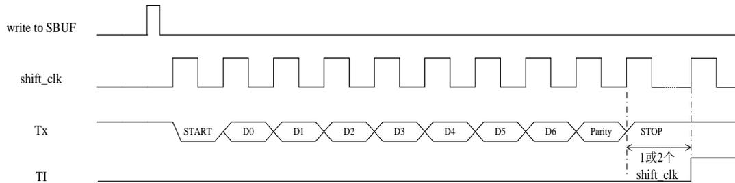
图示：方式 2 时串行发送数据时序
