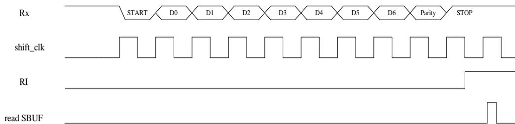
图示：方式 2 时串行接收数据时序
