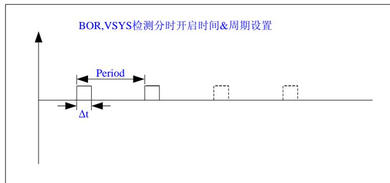
其中Period为LVD\_DET、VSYS\_DET和BOR\_DET检测模块分时开启的周期，可通过VDETPCFG寄存器的VDET\_PRD[2:0]位设置。 $\Delta t$ 是分时检测使能到LVD\_DET、VSYS\_DET和BOR\_DET开始采样的等待时间，可通过VDETPCFG寄存器的VDET\_TIME[1:0]位设置。
