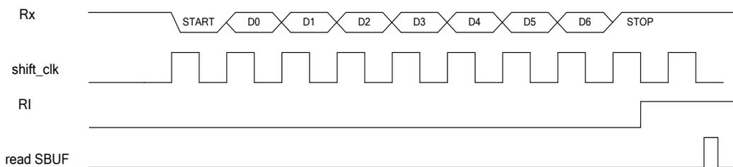
图示：方式 1 时串行接收数据时序
