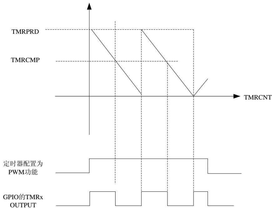
PWM 配置为中央计数方式时，当计数器 TMCNT 从周期寄存器 TMRPRD 的值向下计数值等于比较寄存器 TMRCMP 的值时，PWM 输出管脚发生电平翻转。当计数器 TMCNT 继续向下计数，计数值等于 0 时，PWM 输出管脚再次发生电平翻转。PWM 输出波形如下图所示：
