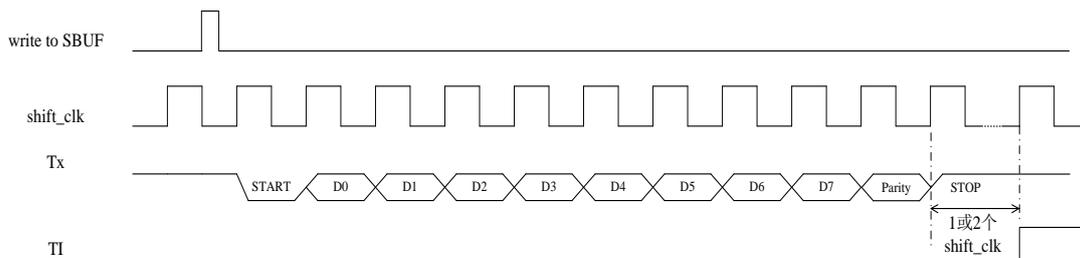
图示：方式 4 时串行发送数据时序
