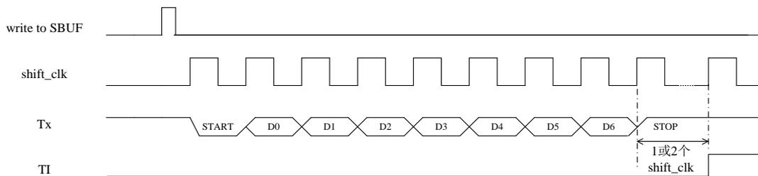
图示：方式 1 时串行发送数据时序
