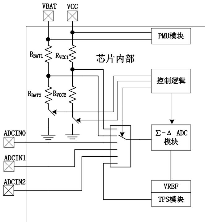
V<sub>BAT</sub> 检测内阻为 30K (R<sub>BAT1</sub> 为 24K, R<sub>BAT2</sub> 为 6K), V<sub>CC</sub> 检测内阻为 42K (R<sub>VCC1</sub> 为 36K, R<sub>VCC2</sub> 为 6K)。ADCIN0, ADCIN1, ADCIN2 内部均无内阻。
