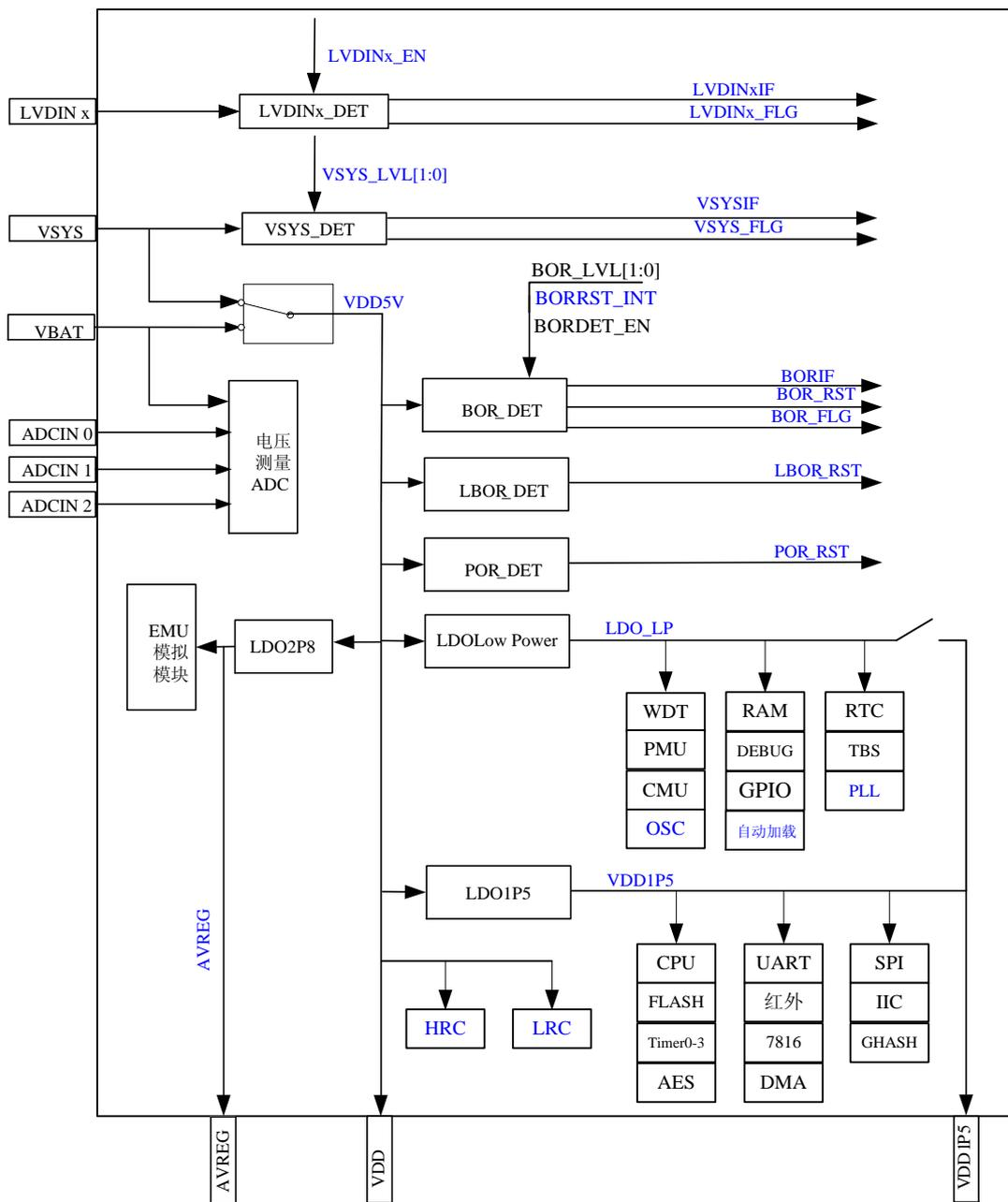
图 4-1 芯片内部供电框图
