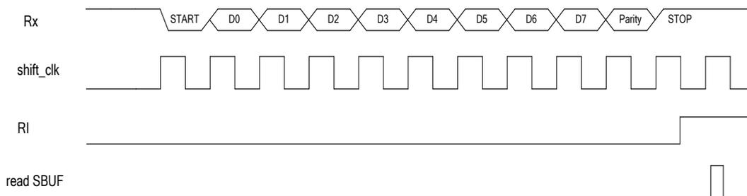
图示：方式 4 时串行接收数据时序
