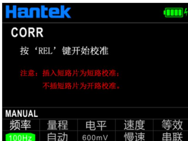
2、短按【REL】键进行开路 (OPEN) 或者短路 (SHORT) 校正, 此时仪器自动识别是开路还是短路。校正成功后, 界面显示“校准成功!”; 校正失败, 则显示“校准失败!”。
