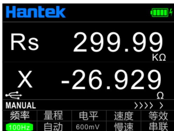
3. 将电阻插入测试槽，或选用合适的测试附件（橡胶插头-鄂鱼夹）接入被测电阻；
