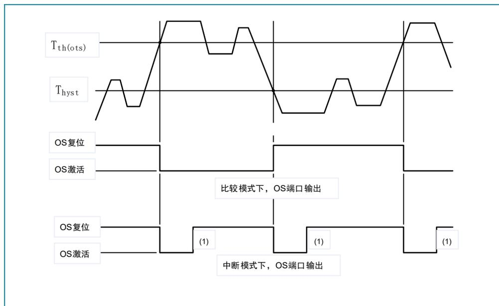
(1) OS 通过读取寄存器或将芯片配置成睡眠模式来重置。假设故障队列在每个  $T_{th(ots)}$  和  $T_{hyst}$  交叉点处满足。
