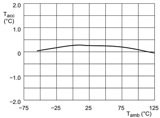
Fig 19. V<sub>CC</sub> = 3.3 V 时典型测温精度
