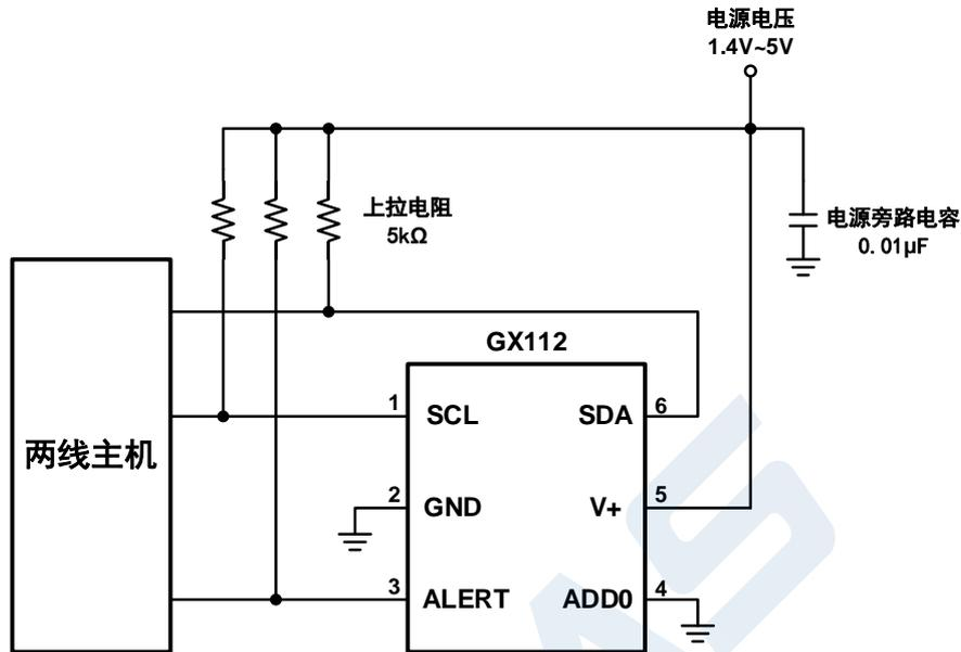
图 10 GX112 的典型连接方式
