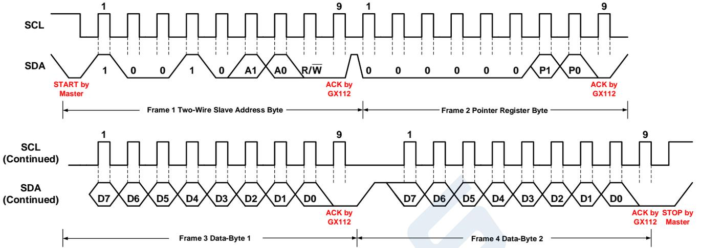
图 6 两线制写命令时序图
