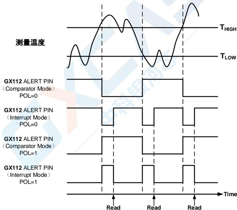
图 5 ALERT 引脚在不同模式下的状态
