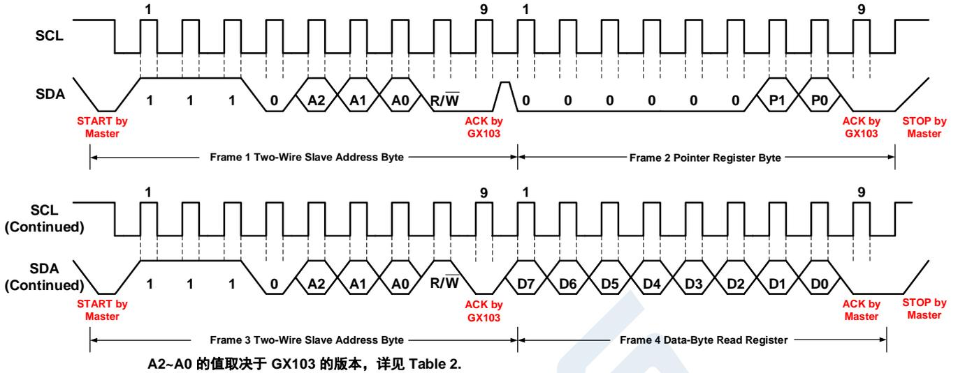
图 5 两线制读命令时序图
