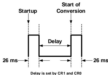
图 2 连续转换示意图
