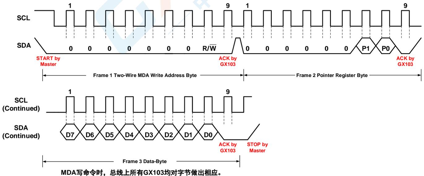
图 6 两线制 MDA 写命令时序图
