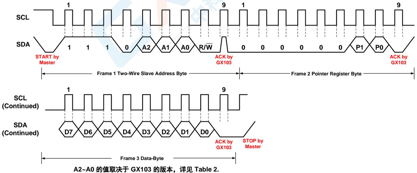
图 4 两线制写命令时序图
