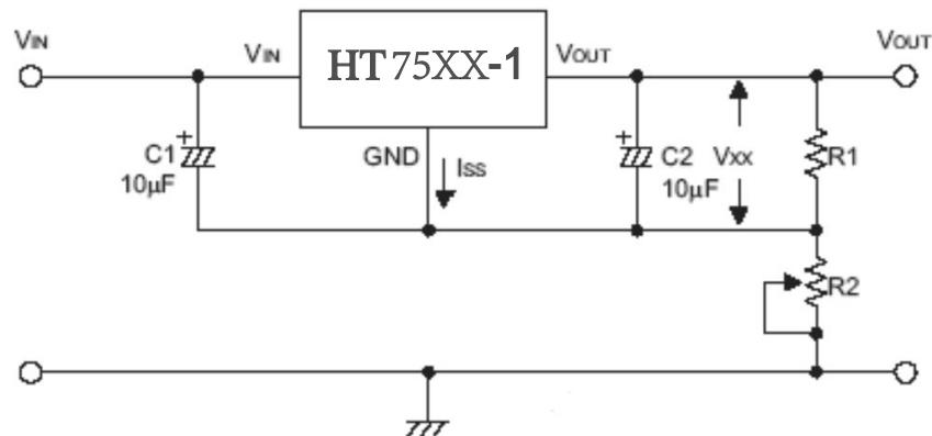
$$V_{OUT} = V_{xx} \left(1 + \frac{R2}{R1}\right) + I_{ss} \cdot R2$$
