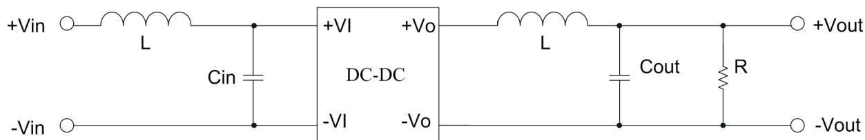
①对于纹波噪声要求较高的场合应外接 LC 滤波电路。
