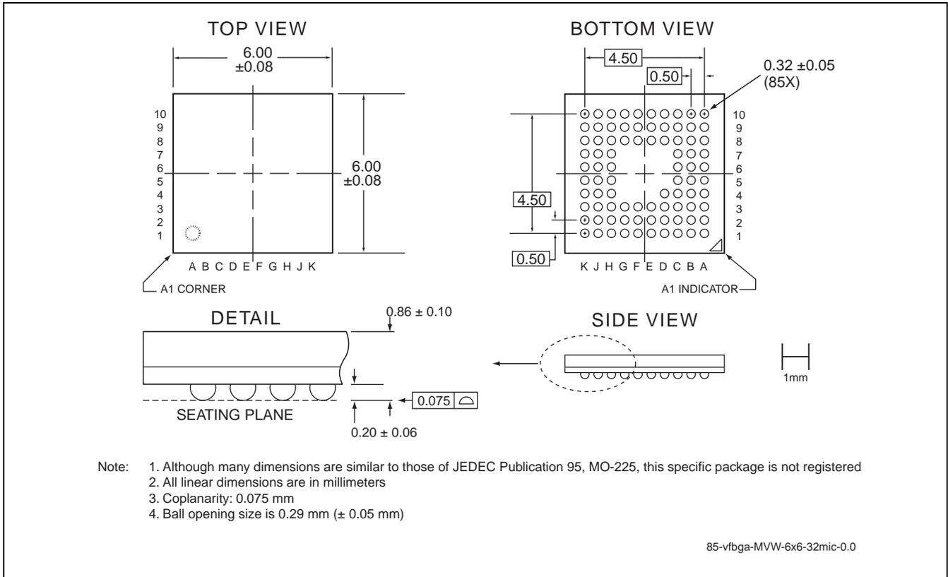
**FIGURE 11: 85-ball Very-Thin, Fine-Pitch, Ball Grid Array (VFBGA)**
